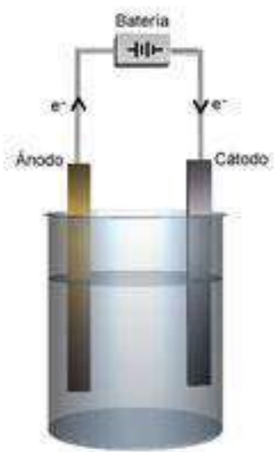
Figura 2.1 Esquema de una celda electroquímica
