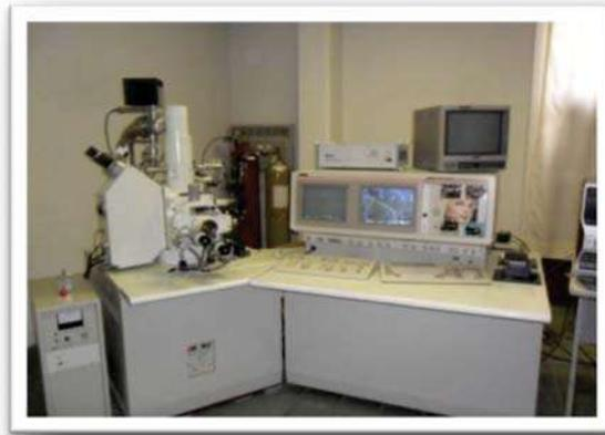
Ilustración 22 Figura 3.5. Microscopio Electrónico de Barrido JEOL, modelo JSM – 6400.
