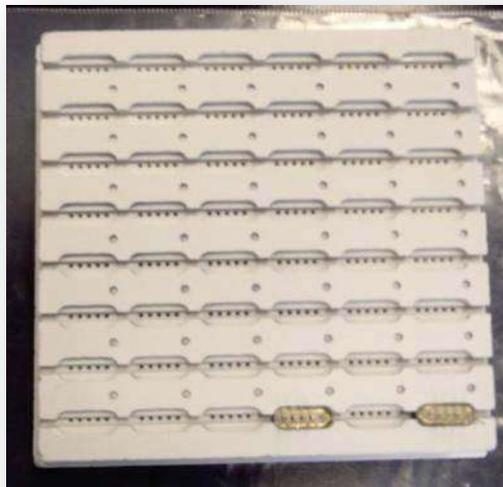
Ilustración 23 Figura 3.6. Portamuestras de grafito puro recubierto con nitruro de boro.
