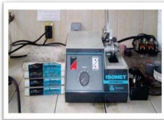
Ilustración 19 Figura 3.2. Cortadora de disco de diamante Isomet Buehler.
