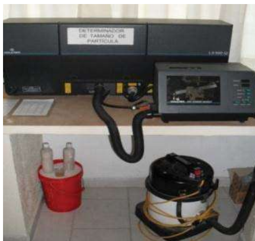
Figura 3. 2.- Fotografía del equipo Beckman Coulter, utilizado para determinar la distribución de tamaño de partícula de las muestras minerales motivo de este estudio.
