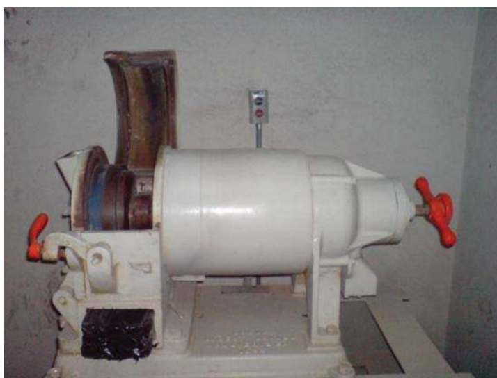
Figura 3. 9.- Pulverizador de discos para reducir el tamaño de las partículas hasta un d_{80} = -70 \mu\text{m} .
