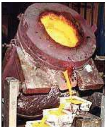
Figura 2.5.- Obtención de Oro como subproducto de fundición.
