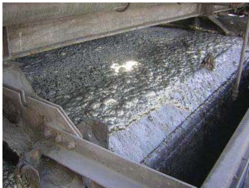
Figura 2.11.- Celda de Flotación.
