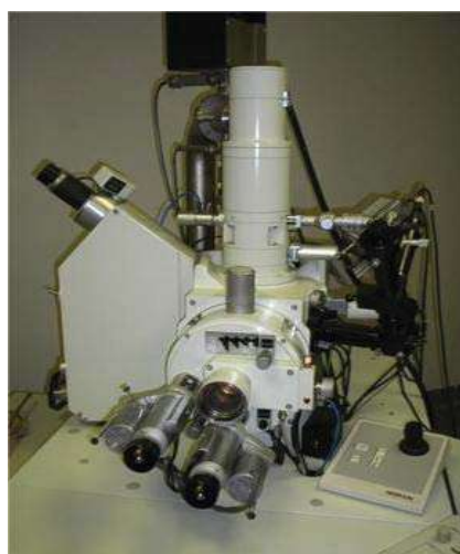
Figura 3. 4.- Detalle del microscopio electrónico de barrido (MEB) que se usó para el análisis químico cualitativo e identificar el grado de liberación del mineral.
