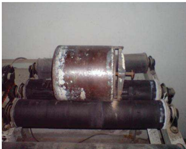
Figura 3. 10.- Molino de bolas de cerámica utilizado para la molienda del mineral y lograr reducciones de tamaño con d_{80} = - 20 \mu\text{m} .
