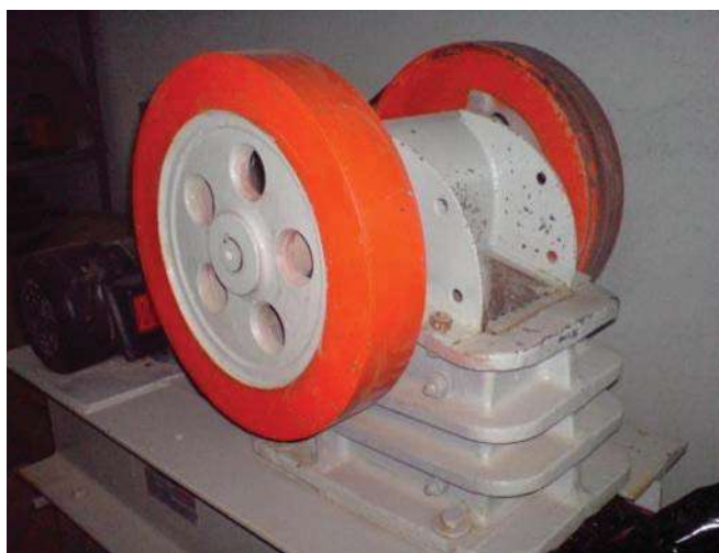
Figura 3. 7.- Trituradora de quijadas empleada para la reducción primaria de tamaño de partícula.
