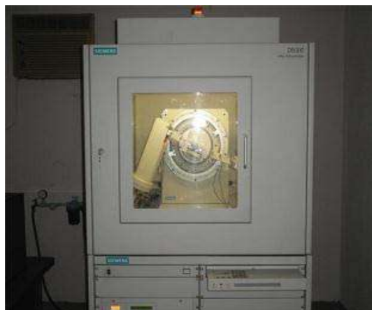
Figura 3. 3.- Difractómetro de rayos X empleado para identificar las especies mineralógicas contenidas en el mineral de estudio.
