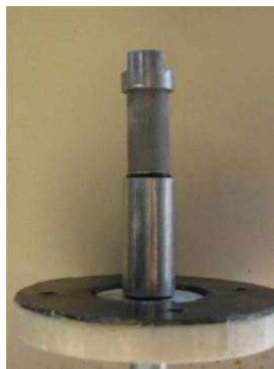
Figura 3. 14.- Fotografía del dispersor poroso instalado en la base interna de la columna.
