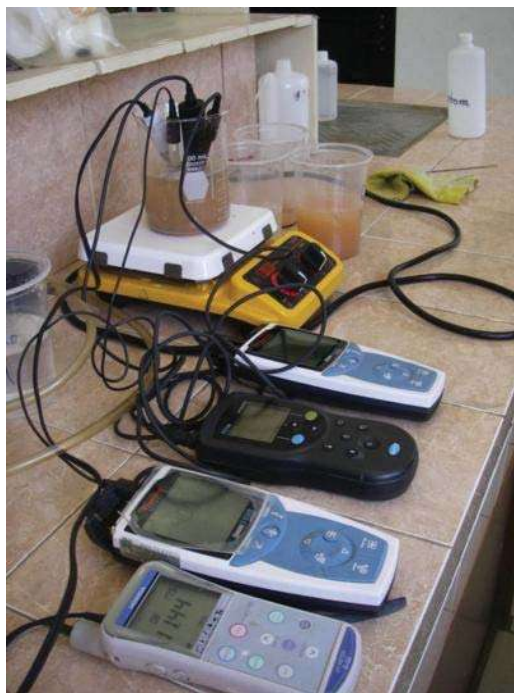
Figura 3. 16.- Arreglo experimental del proceso de lixiviación de las muestras provenientes de la flotación.
