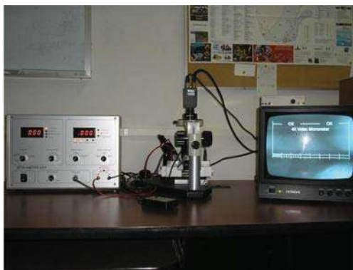
Figura 3. 11.- Arreglo del equipo para medir potencial zeta a las partículas de sílice y magnetita.
