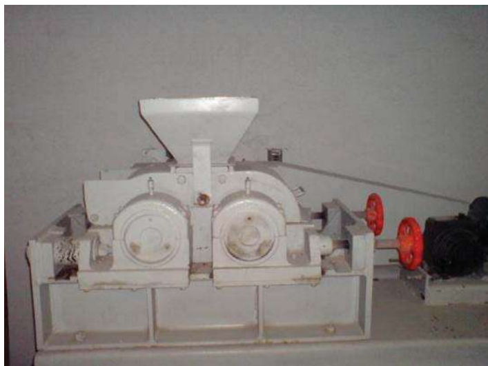
Figura 3. 8.- Trituradora de rodillos empleados para la reducción secundaria de las partículas provenientes de la trituración primaria.
