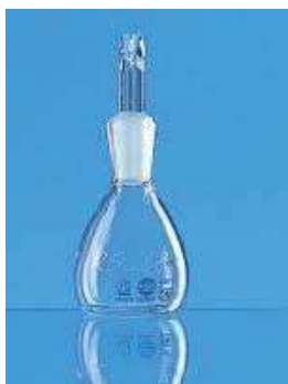
Figura 3. 5.- Picnómetro para estimar la densidad del mineral, de acuerdo a la norma estandarizada INV E-707-07.
