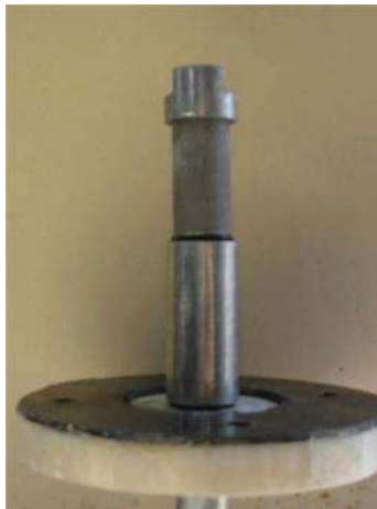
Figura 2.13.- Tapón poroso por donde se inyecta el aire a la columna.
