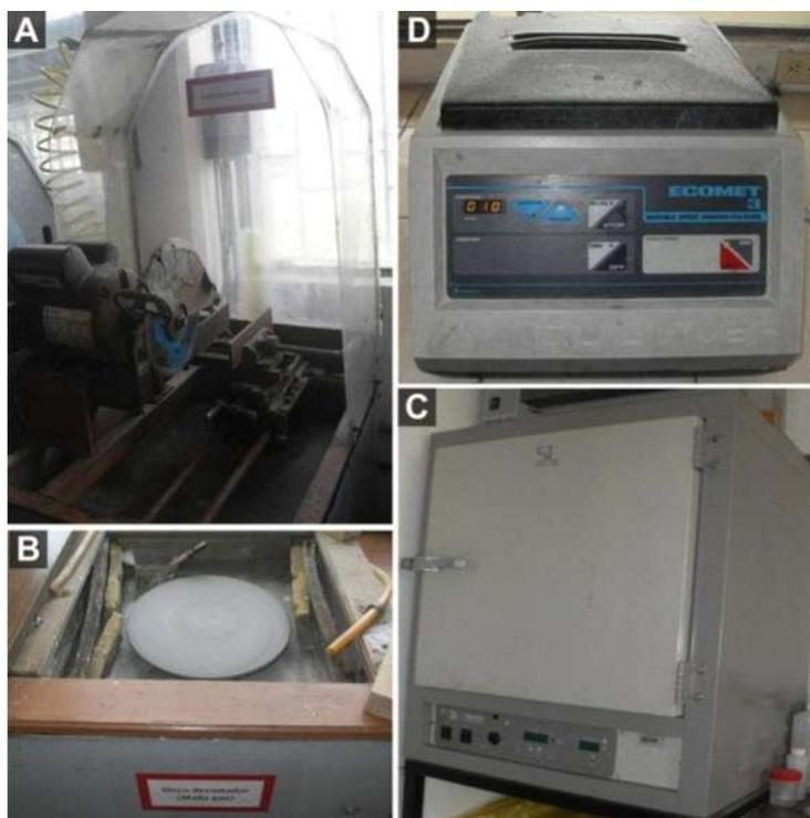
**Figura 3.** A) Cortadora de disco de diamante, B) Disco desbastador, C) Mufla de secado y D) Equipo de Pulido.
