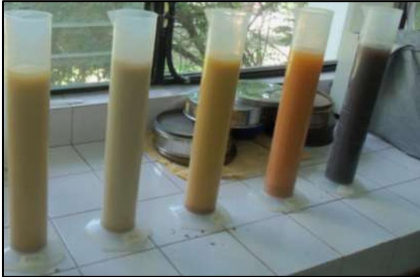
Figura 57. Prueba de sedimentación, para conocer el porcentaje de granos finos (limos y arcillas), en las muestras recolectadas en campo.
