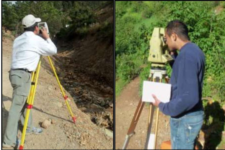
Figuras 51 (izquierda) y 52 (derecha). Trabajos de levantamiento topográfico con Estación Total sobre el cauce del río San Pedro.
