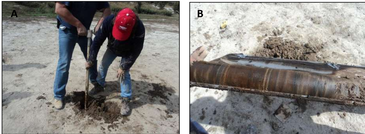
Figura 7. A) Utilización del sondeador tipo Ruso en la extracción de los núcleos de sedimentos en La Alberca Valle de Santiago, Guanajuato. B) Aprender en el sondeador las facies de láminas y bandas en los sedimentos.
