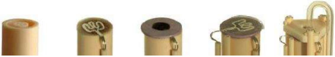
Figura 3.9 Montaje de la muestra en la celda. De izquierda a derecha: a) montaje del tubo de soporte, b) conexión del electrodo inferior, c) posicionamiento de la muestra, d) conexión del electrodo superior y del termopar y e) aseguramiento de la muestra con el ensamble triangular de alumina y alimentación de gas en la cámara externa (opcional) [45].
