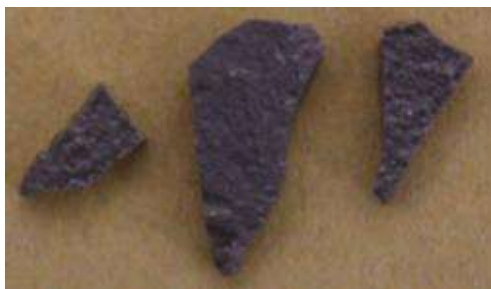
Figura 4.18 La muestra de 15GDC obtenida por PECS a 1300°C con 5min de tiempo de permanencia y una presión aplicada de 60 MPa se fracturó en partes irregulares.
