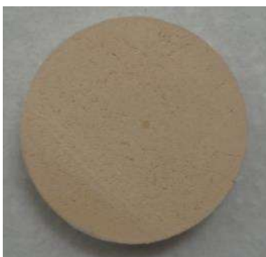
Figura 4.25 Muestra 15GDC-1201 después del sinterizado por PECS y el recocido a 1100^{\circ}\text{C} con velocidad de calentamiento de 4^{\circ}\text{C}/\text{min} y un tiempo de permanencia de 24h. Un cambio en la coloración de la misma es debido a la reoxidación del cerio al ser tratado térmicamente en aire.
