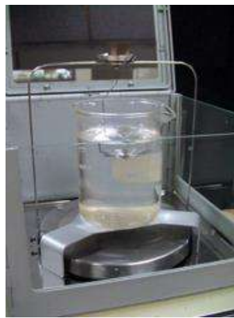
Figura 3.4 Montaje experimental para medir la densidad de las muestras mediante el método de Arquímedes.
