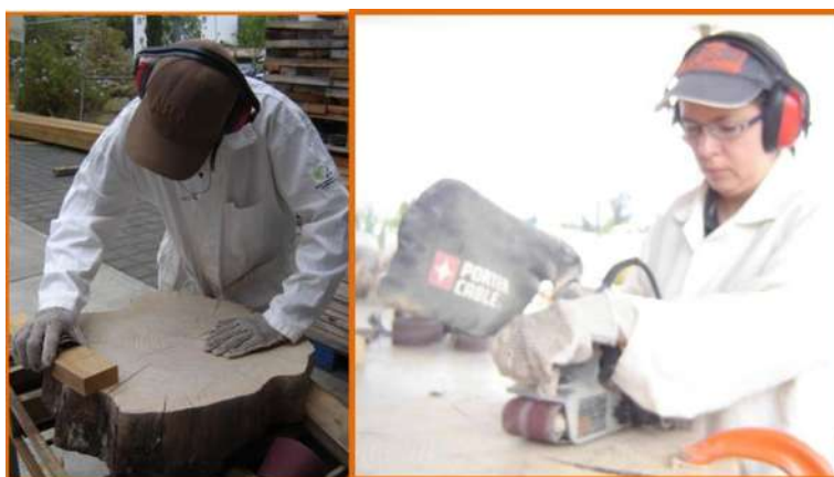
Figura 39 Lijado de secciones transversales con lijadora de bandas y acabado a mano
