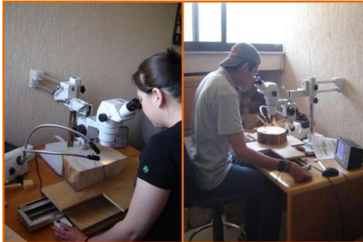
Figura 45 Equipo de medición de anillos de crecimiento, Velmex con platina Laboratorio de Ecología del manejo de recursos naturales, CIECO-UNAM-MORELIA
