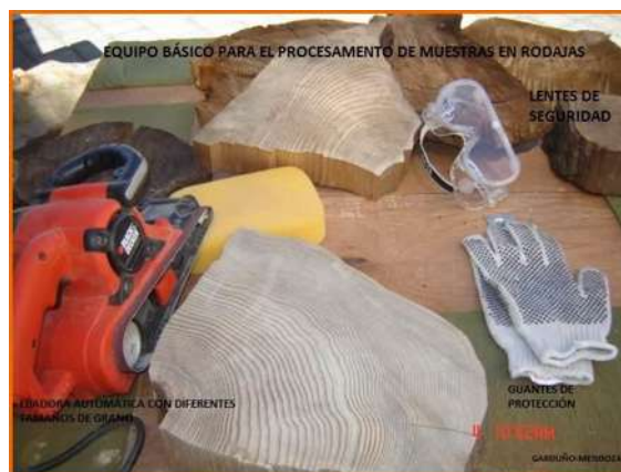
Figura 40 Equipo utilizado para el lijado de las secciones transversales
