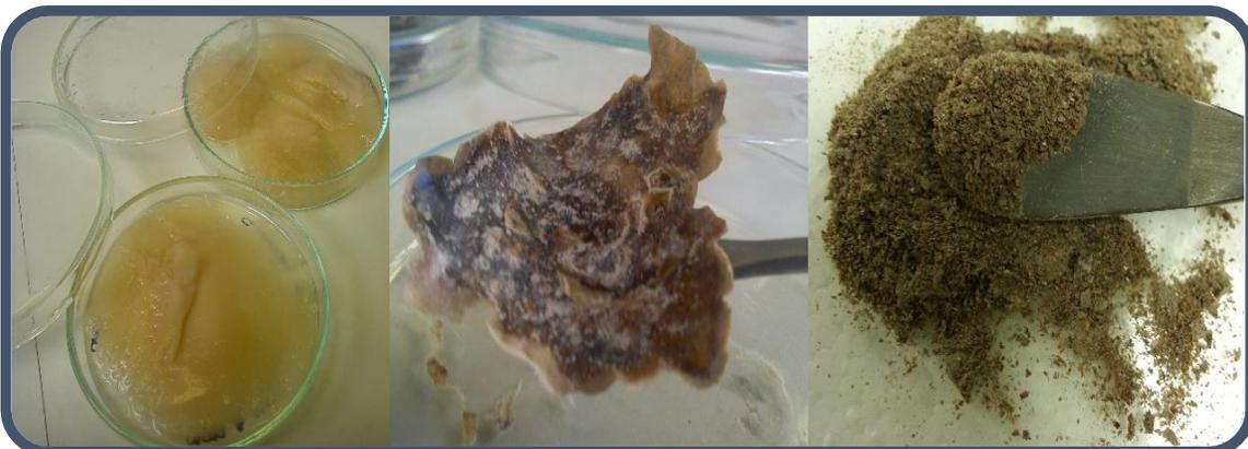
**Figura 3.6.** Biomasa húmeda (derecha), biomasa seca (centro) y biomasa seca pulverizada con mortero de porcelana (izquierda).
