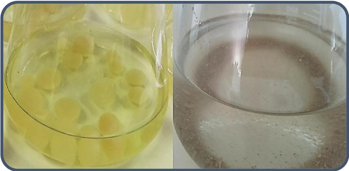
**Figura 3.9.** Soluciones implementadas para determinación de las isotermas de adsorción con pellets (derecha) y biomasa pulverizada (izquierda).
