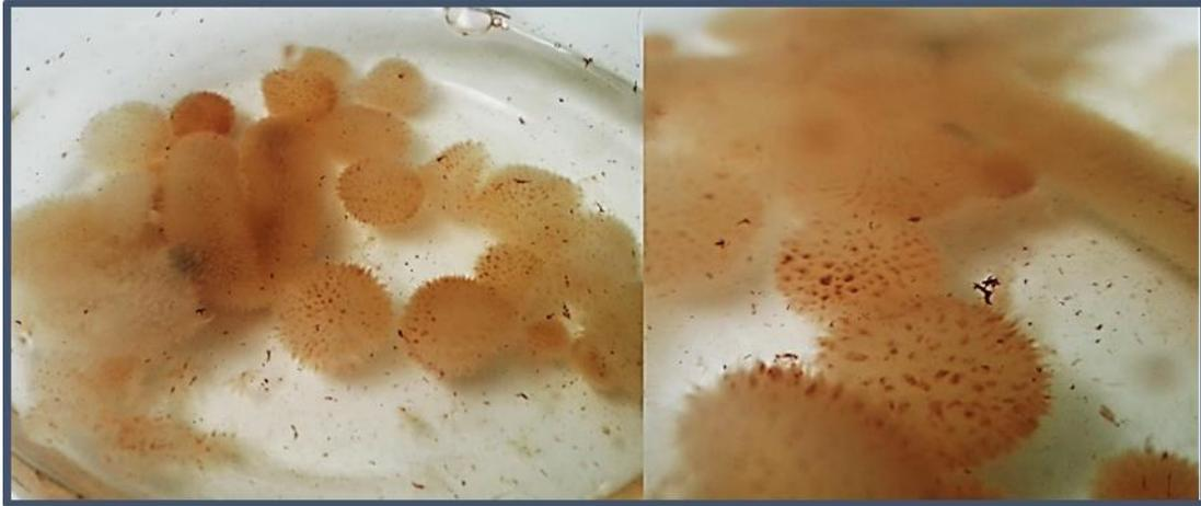
**Figura 4.65.** Pellets con pigmentación rojiza posterior al contacto en la solución de oro.
