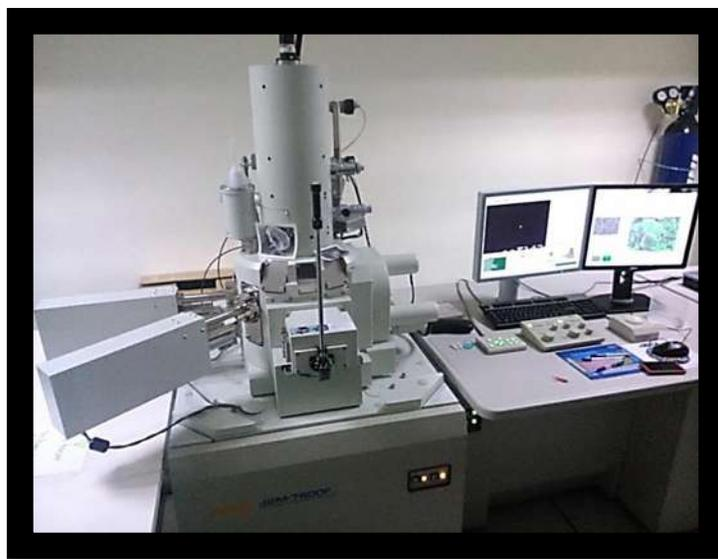
**Figura 2.9.** Microscopio electrónico de barrido JEOL JSM-7600F.
