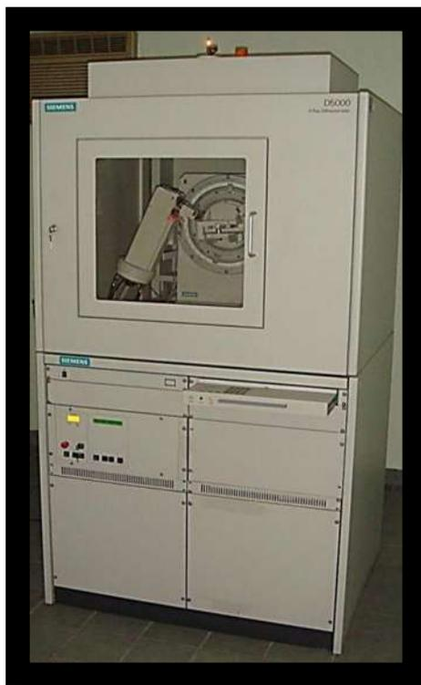
**Figura 2. 8.** Difractómetro de Rayos X Siemens D5000.
