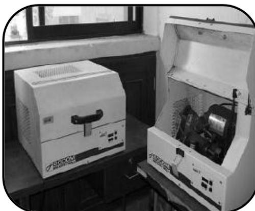
**Figura 2. 2.** Equipo de molienda SPEX 8000-M.
