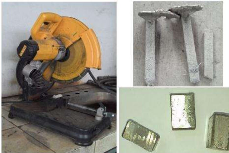
Figura 3. 2 Cortadora de disco abrasivo y probetas antes de cortar y después.
