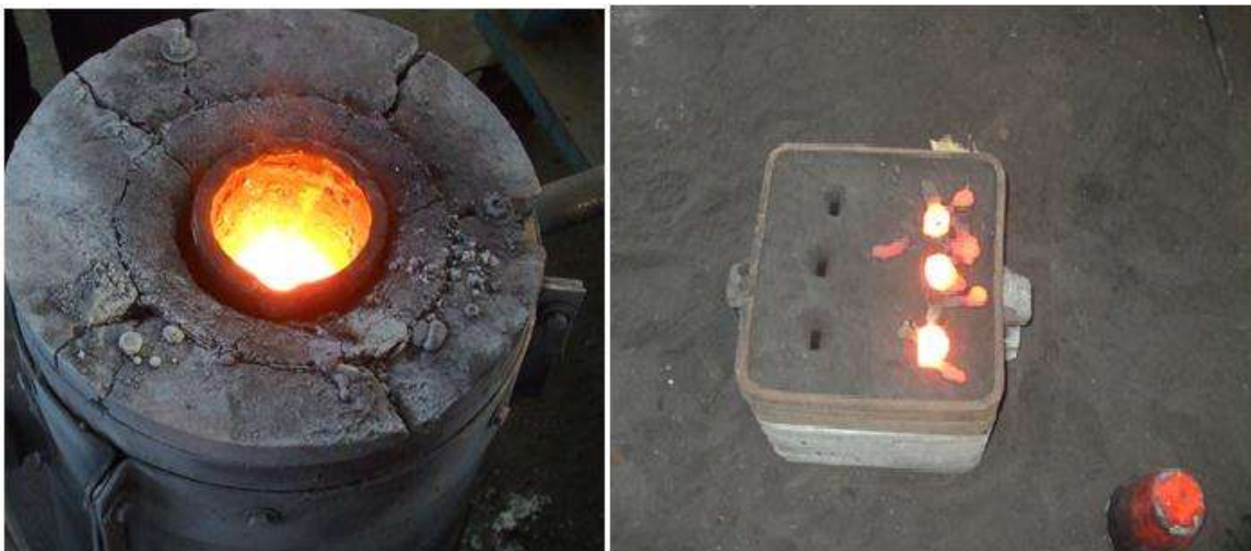
Figura 3. 1 Horno de inducción y colada de la aleación en molde de arena.
