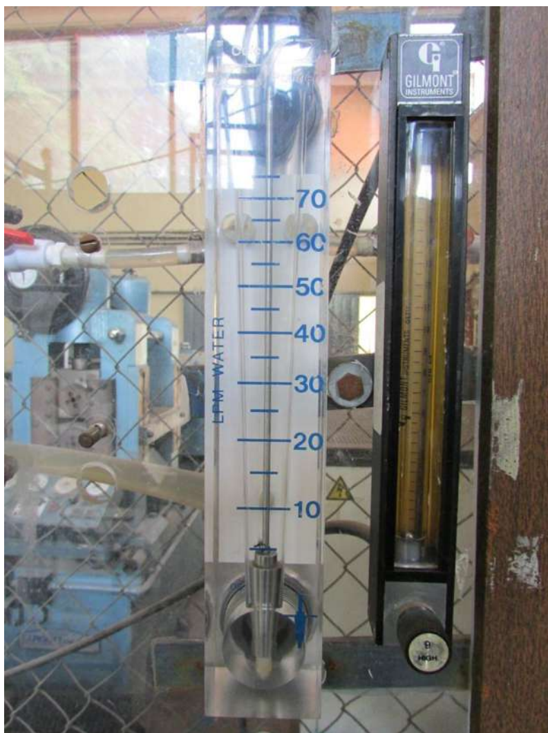
Figura 3.10. Rotámetros de esfera para medir los flujos de agua y aire alimentados al dispersor
