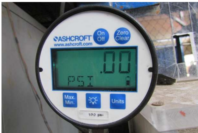
Figura 3.11. Transductor de presión digital utilizado para medir la caída de presión dentro de cada ventury
