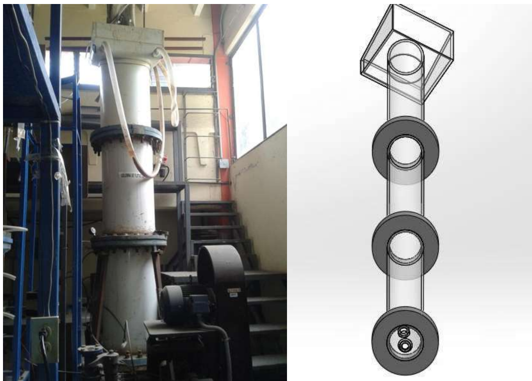
Figura 3.16. Vista lateral de la columna de flotación de escala piloto (izquierda), vista isométrica de la columna (derecha)
