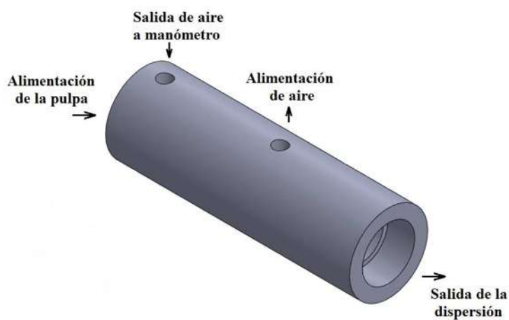
Figura 3.6. Vista isométrica de un dispersor externo tipo ventury
