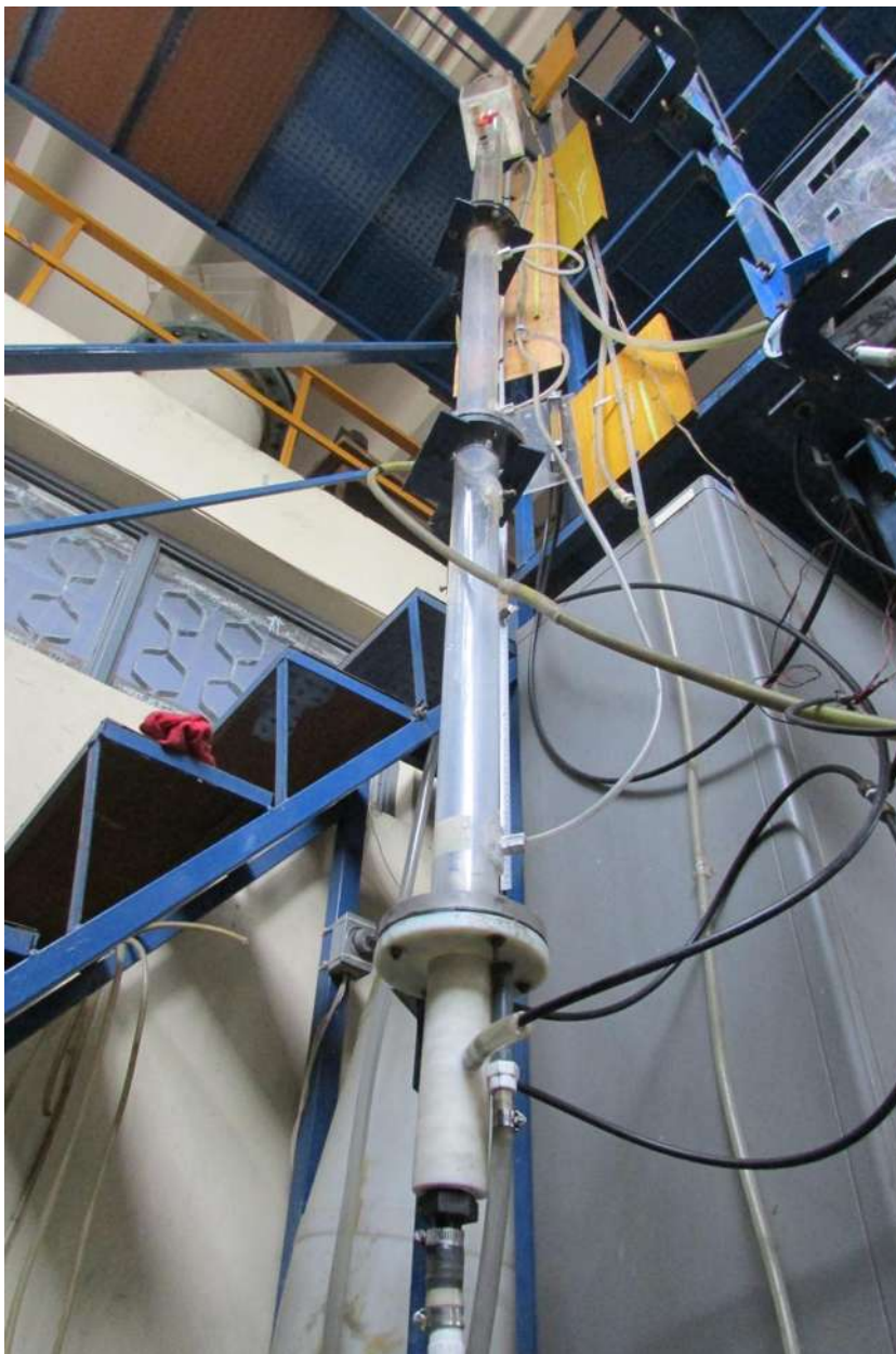
Figura 3.2. Columna de flotación de 7.5 cm de diámetro y 300 cm de altura
