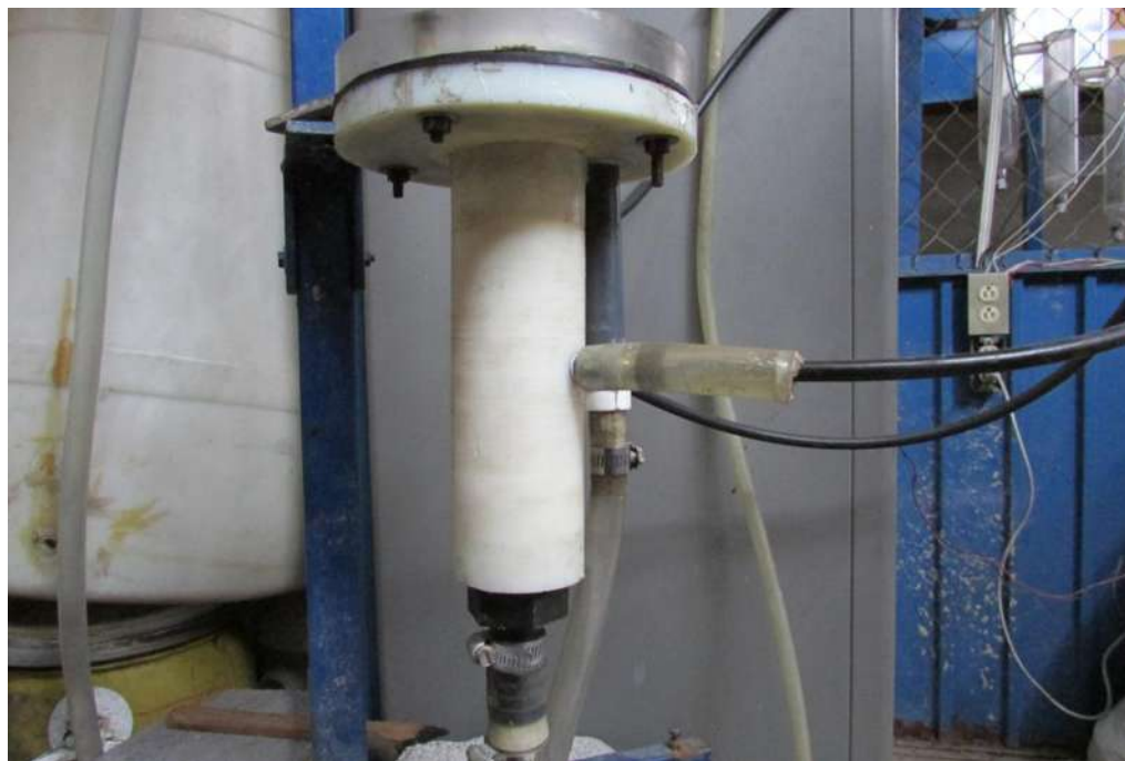
Figura 3.9. Instalación de dispersor en la parte inferior de la columna de flotación
