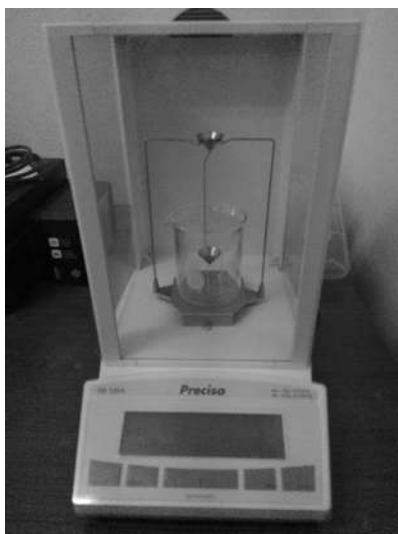
Figura 2.9. Balanza analítica y kit de medición de densidad por el método de Arquímedes.
