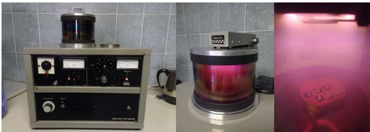
Figura 2.6. Metalizadora de Cu.
