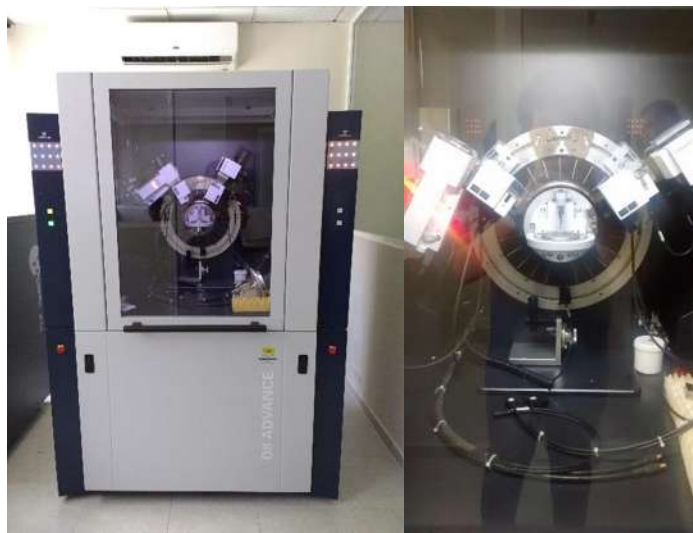
Figura 2.4. Difractómetro Bruker D8 Advance, exterior e interior.
