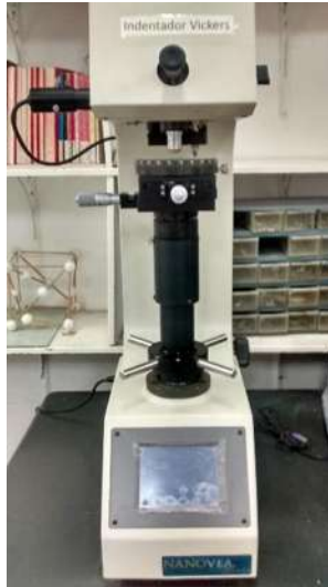
Figura 2.8. Microindentador Vickers Nanovea Hardness Tester, de Micro Photonics Inc.
