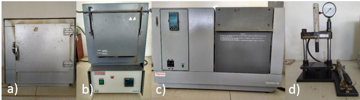
Figura 2.10. (a) Horno de secado, (b) horno de baja temperatura TS FD1545M, (c) horno de alta temperatura TS F46110CM-33, y (d) prensa uniaxial Otonf NT-5H.
