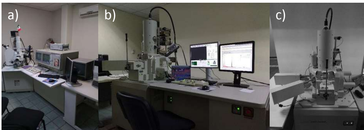
Figura 2.5. a) Microscopio JEOL JSM-6400, b) Microscopio de emisión de campo JEOL JSM-7600F, y c) columna de análisis del microscopio de emisión de campo.
