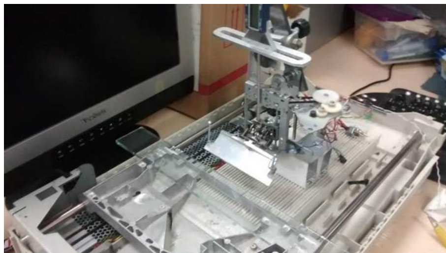
Figura 2.2. Equipo de recubrimiento por flujo de diseño y construcción propia.
