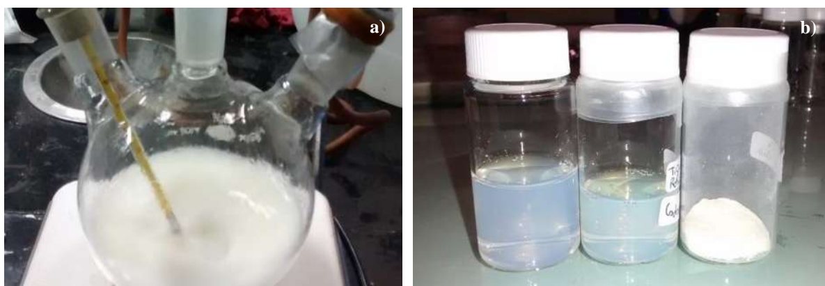
Figura 2.5. a) Reactor de tres bocas con sistema de reflujo, b) coloides obtenidos y polvo de \text{TiO}_2 .
