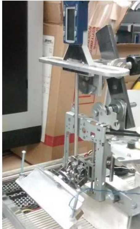
Figura 2.3. Rasero de recubrimiento ensamblado en el carro vertical del equipo y micrómetro para la medición de espesores.
