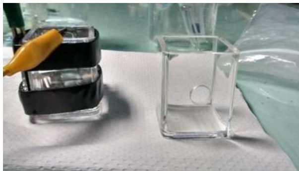
Figura 2.1. Celda de acrílico transparente para mediciones fotoelectroquímicas de diseño propio.
