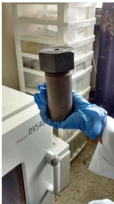
Figura 2.4. Autoclave de acero para la realización de los tratamientos hidrotermales del sol de anatasa codopada.
