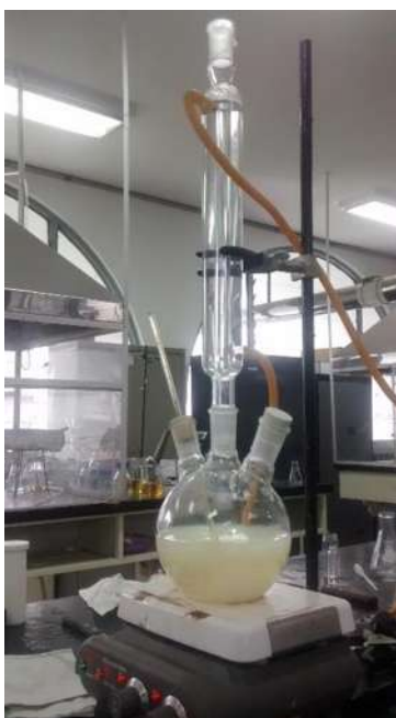
Figura 2.3. Sistema de reflujo para la reacción del precursor de anatasa con los ácidos u agentes dopantes.
