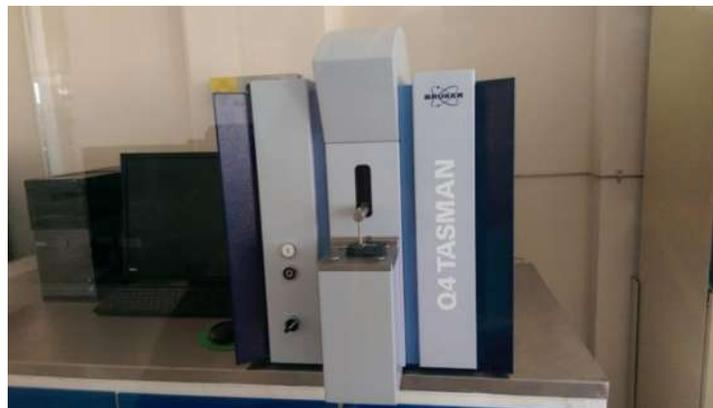
Figura 2.4: Espectrómetro por emisión óptica.
