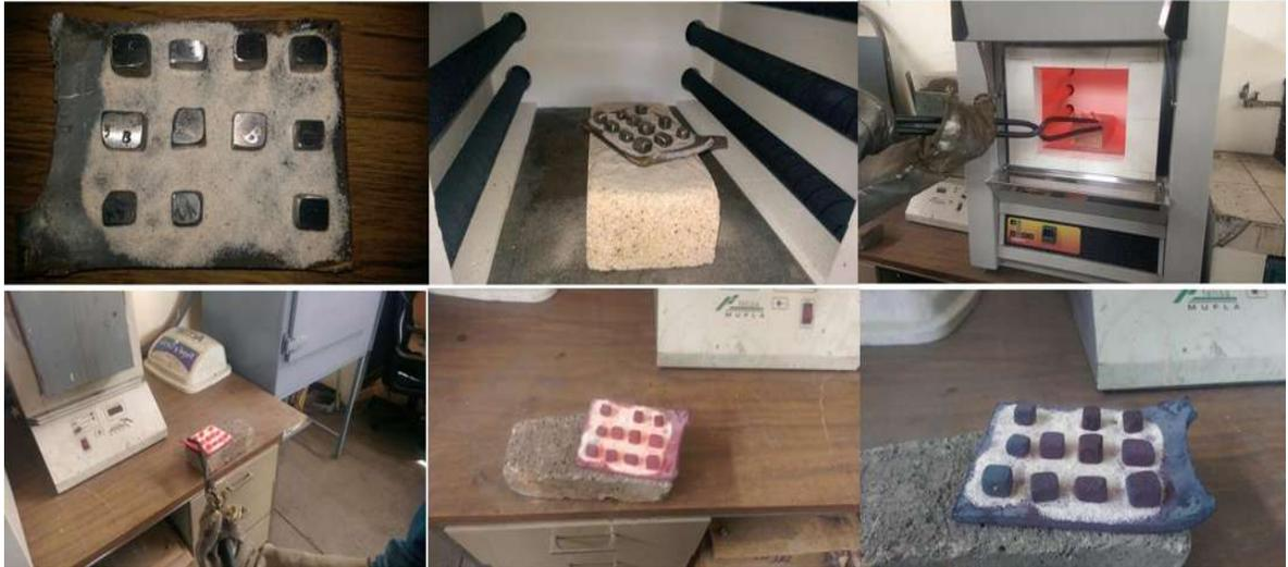
Figura 2.10: Procedimiento para el tratamiento térmico a las muestras.
