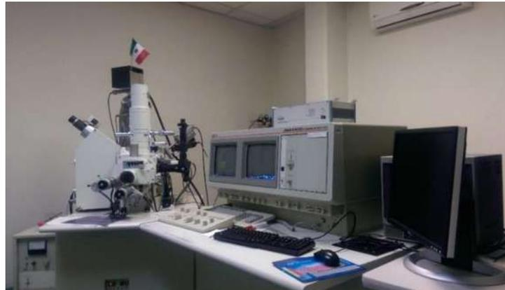
Figura 2.16: Microscopio electrónico de barrido.
