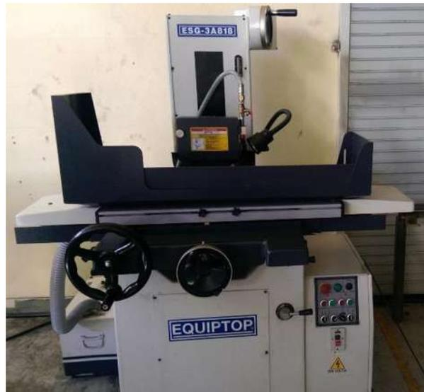
Figura 2.7: Rectificadora utilizada para preparar las muestras de análisis químico.
