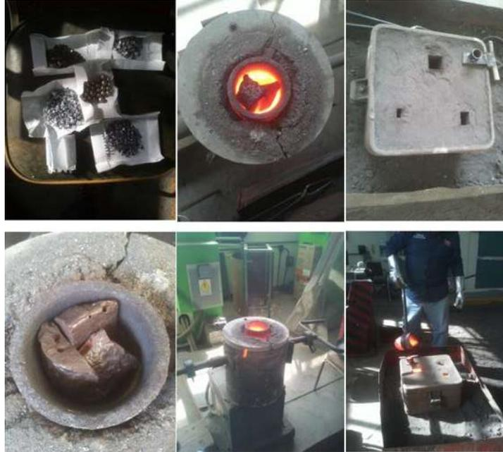
Figura 2.2: Horno de inducción y colada de la aleación en molde de arena.
