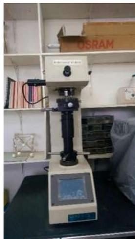
Figura 2.17: Durómetro Vickers.
