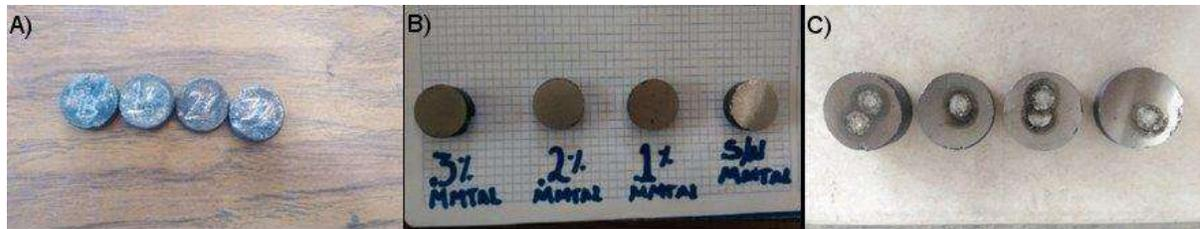
Figura 2.6: Muestras para análisis químicos con diferentes adiciones de mischmetal. A) Condiciones de colada, B) Rectificadas, C) Después del ensayo de chispa.
