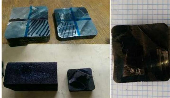
Figura 2.3: Cortes de sección trasversal de las probetas con dimensiones 2.5x2.5x1 cm para ensayos de desgaste.
