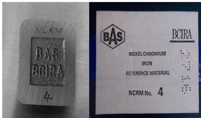
Figura 2.5: Estándar de calibración NCRM No. 4, utilizado como referencia para hacer el análisis químico.
