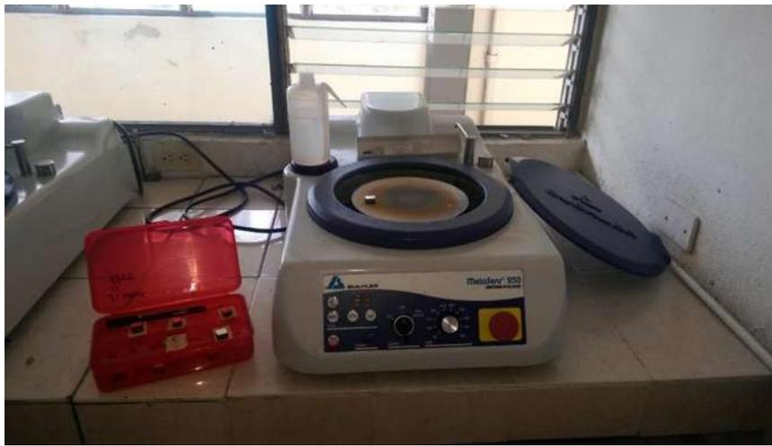
Figura 2.12: Pulidora metalográfica.
