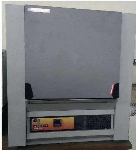
Figura 2.8: Horno de resistencias eléctricas.
