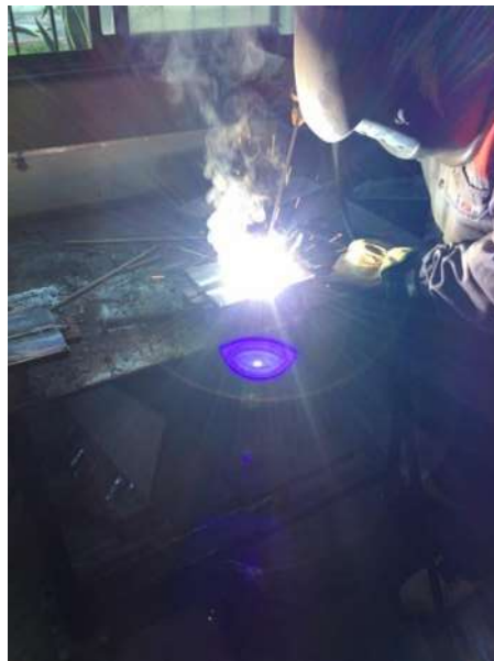
Figura 2.6 Soldadura de placas
