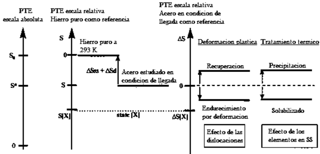
Figura 1.12 Representación esquemática de la variación de las mediciones PTE en escala relativa y absoluta
