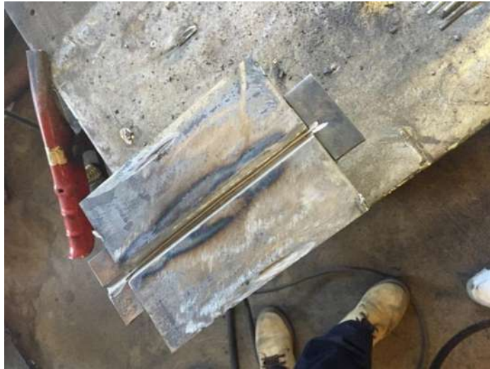
Figura 2.5 Preparación de placas a soldar
