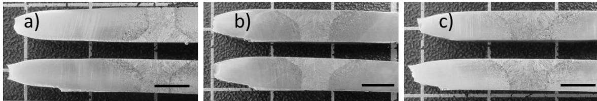
**Figura 4.25.** Fracturas del ensayo de tensión de las soldaduras: a) sin campo, b) campo perpendicular y c) campo axial. La cota equivale a 5mm.
