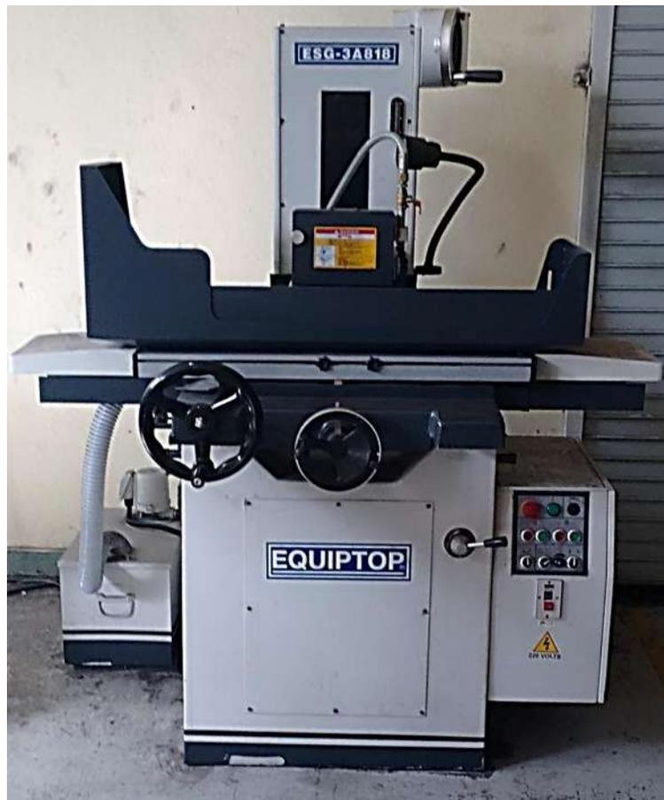
**Figura 3. 4** Máquina rectificadora.
