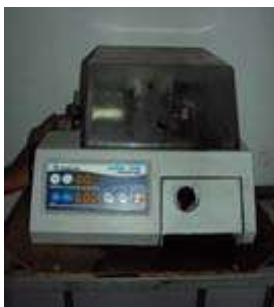
Figura 2.11. a) Cortadora de disco de diamante BUEHLER® isomet 1000 b) Probetas de desgaste de acero TWIP.
