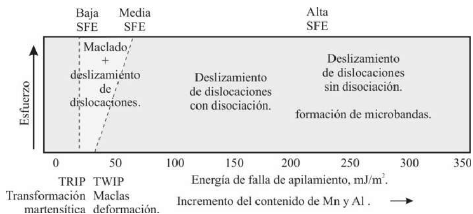
Figura 1.2. Relación entre SFE y el mecanismo de operación de deformación en metales y aleaciones FCC [4].
