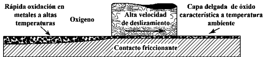
Figura 1.20. Oxidación rápida de superficies metálicas a altas temperaturas de contacto [33].
