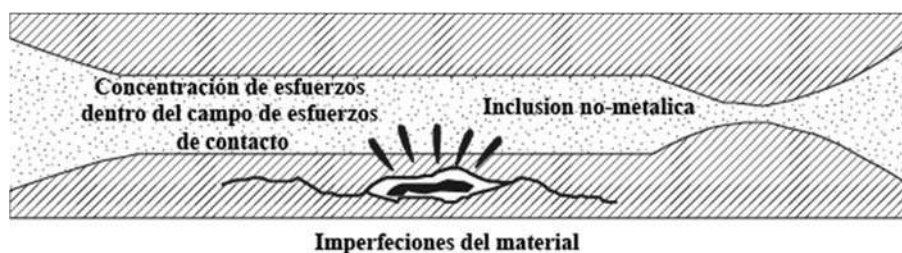
Figura 1.12. Imperfección en el material como una causa de fatiga por contacto [33].
