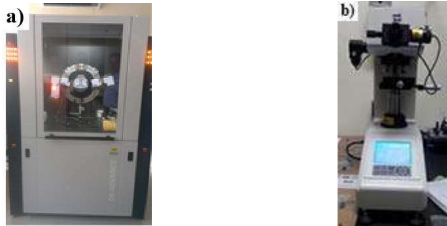
Figura 2.8. a) Difractómetro BRUKER® D8 advance b) Microdureómetro Vickers time®.
