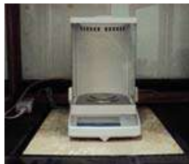
Figura 2.13. Balanza analítica METTLER TOLEDO® automática de alta precisión.
