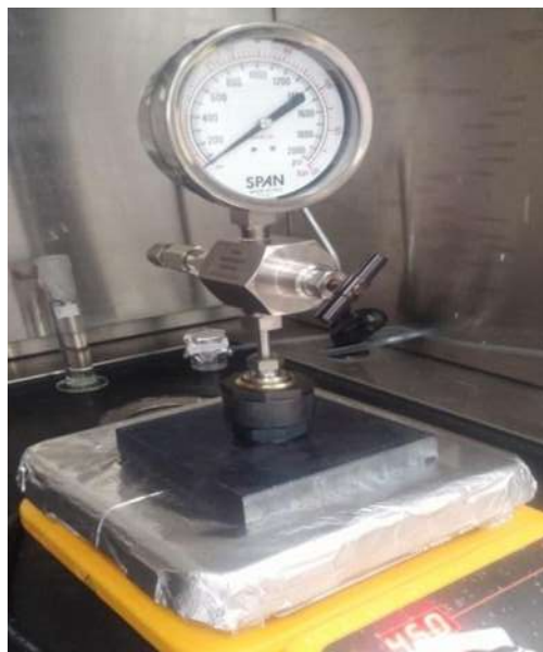
Figura 3.3. Arreglo de autoclave con manómetro y mufla de calentamiento utilizados en el procesamiento hidrotermal para la síntesis de anatasa nanoestructurada.
