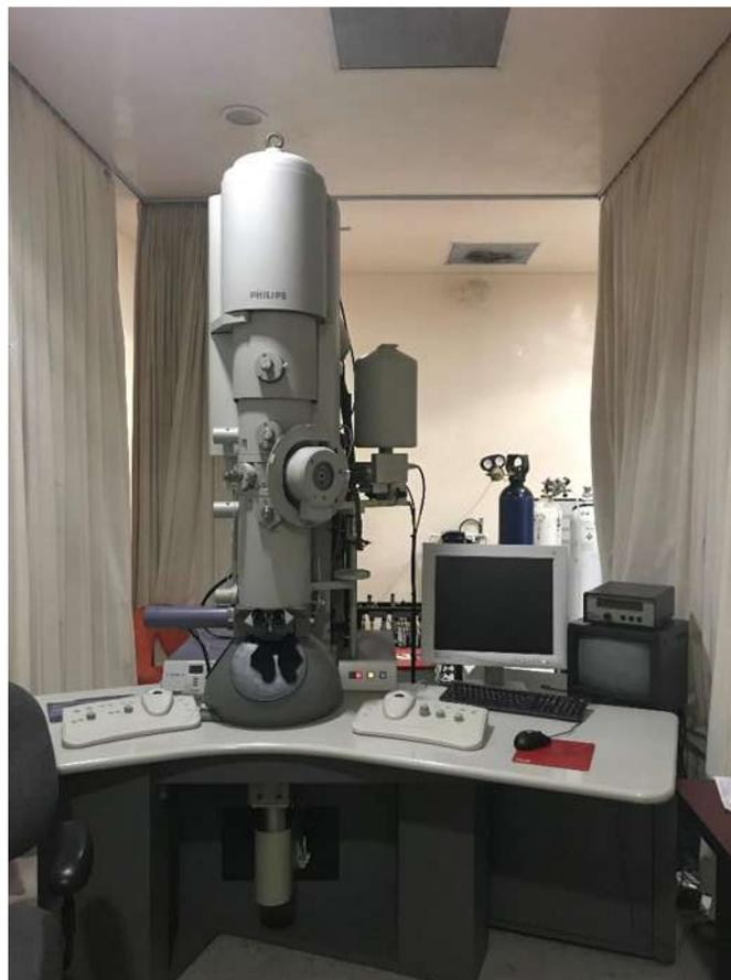
Figura 3.8 Microscopio electrónico de transmisión.
