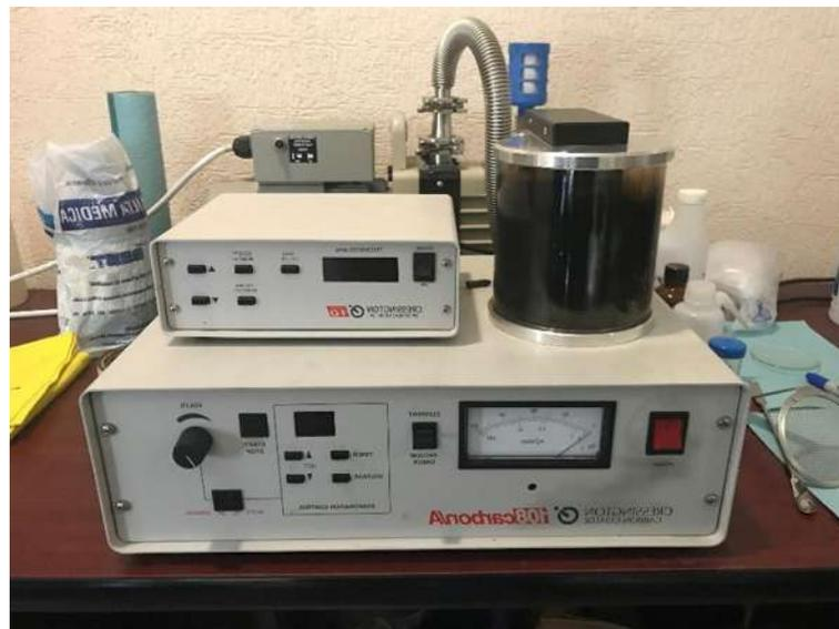
Figura 3.7 Metalizadora 108 Carbon/A
