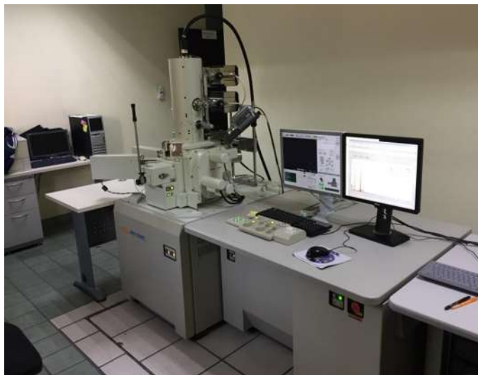
Figura 3.4. Microscopio electrónico de barrido
