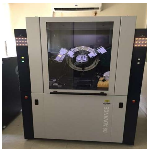
Figura 3.3. Difractómetro D8 Advance.
