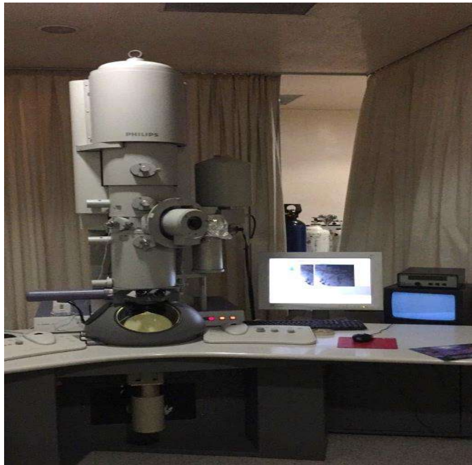
Figura 3.5. Microscopio electrónico de transmisión.
