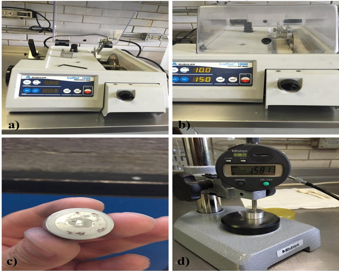
Figura 3.6. Procedimiento para preparación de las probetas de microscopía electrónica de transmisión, a) armado de la cortadora, b) proceso de cortado del material, c) lijado y desbastado del material, y d) medición del espesor del material.
