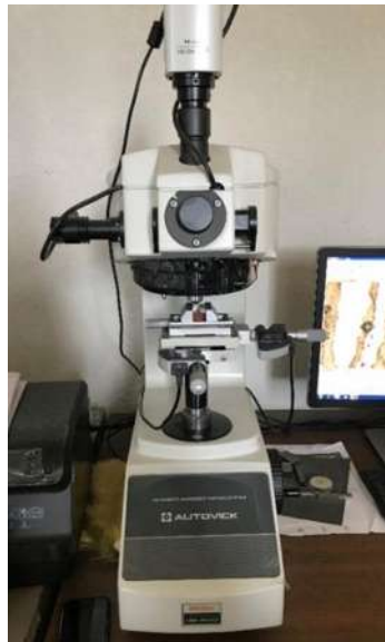
Figura 3.12 Microdurómetro marca Mitutoyo donde se realizaron las mediciones de microdureza.
