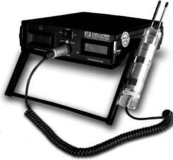
**Figura 3. 14** Equipo de ensayos no destructivos Thermo-Sorter Walker Scientific Inc.
