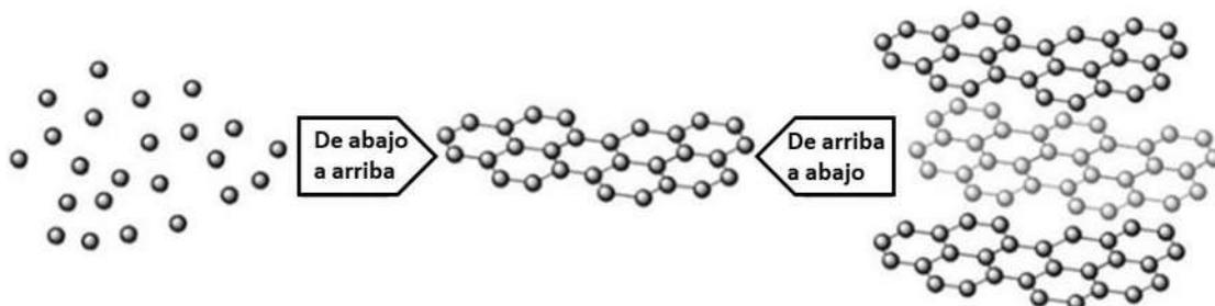
**Figura 2.1** Esquema de la síntesis de grafeno “de abajo-arriba” y “de arriba-abajo” [56].
