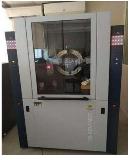
**Figura 3.5** Difractómetro BRUKER D8 ADVANCE
