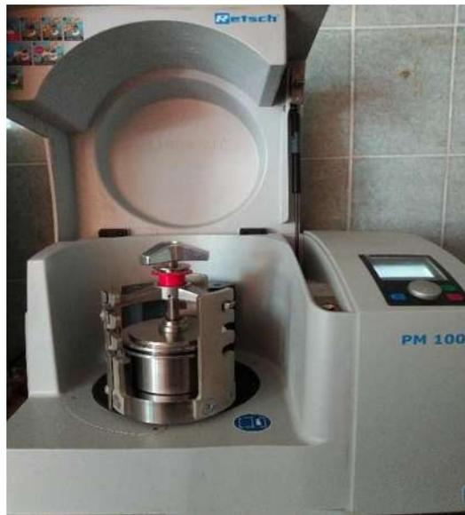
**Figura 3.2** Molino de bolas planetario
