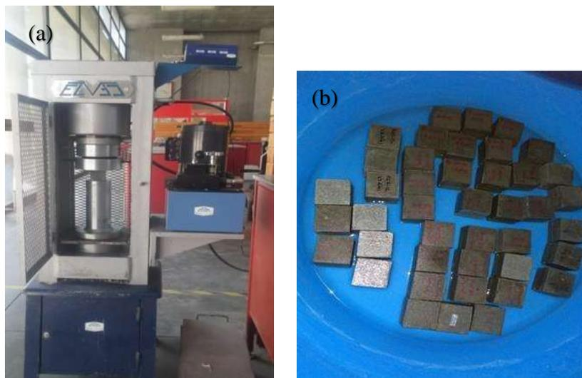
**Figura 3.4** a) Prensa Hidráulica modelo E 659-2 marca ELVEC y b) morteros curados en agua a temperatura ambiente
