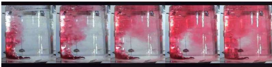
Figura 39. Fotografía tomada a los 4, 6, 8, 10 y 16 segundos después de la inyección del trazador del caso 5 con un flujo de 1.50 lts / min. por cada tapón.
