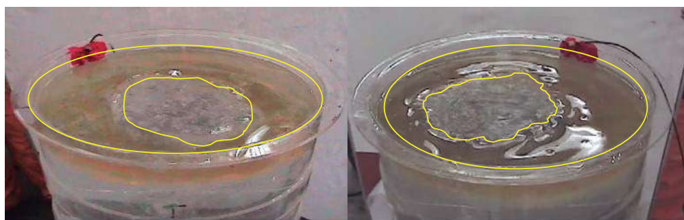
Figura 56. Fotografía de la apertura de escoria del caso 4 con un flujo de 3.0 lts. /min.
