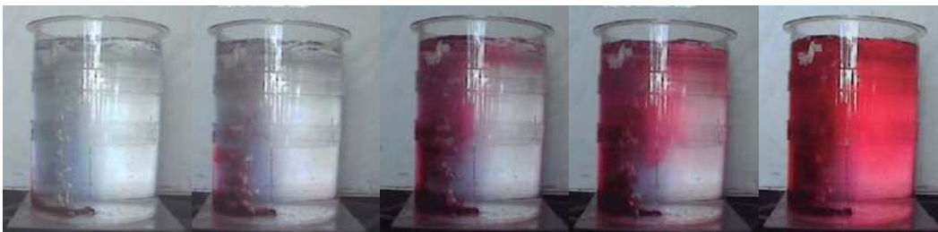
Figura 28. Fotografía tomada a los 4-6-8-10-16 segundos después de la inyección del trazador del caso 3 con un flujo de 2.45 lts / min. por cada tapón.
