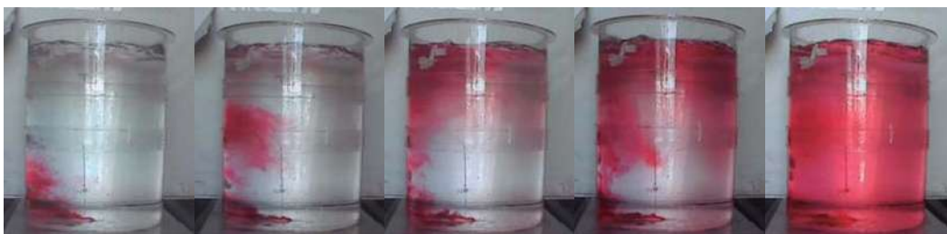
Figura 26. Fotografía tomada a los 4,6, 8, 10 y 16 segundos después de la inyección del trazador del caso 1 con un flujo de 4.90 lts / min.
