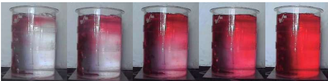
Figura 27. Fotografía tomada a los 4,6, 8, 10 y 16 segundos después de la inyección del trazador del caso 2 con un flujo de 2.45 lts / min. por cada tapón.
