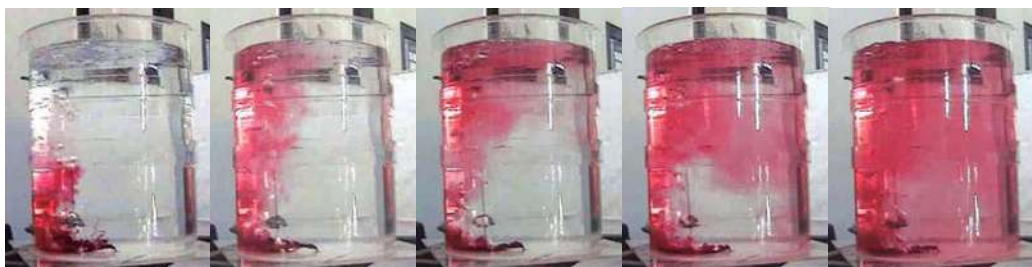
Figura 37. Fotografía tomada a los 4-6-8-10-16 segundos después de la inyección del trazador del caso 3 con un flujo de 1.50 lts / min. por cada tapón.
