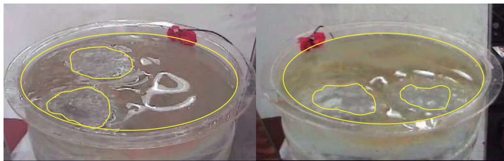
Figura 55. Fotografía de la apertura de escoria del caso 3 con un flujo de 3.0 lts. /min.
