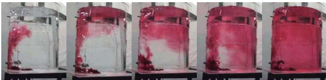
Figura 36. Fotografía tomada a los 4,6, 8, 10 y 16 segundos después de la inyección del trazador del caso 2 con un flujo de 1.50 lts / min. por cada tapón.
