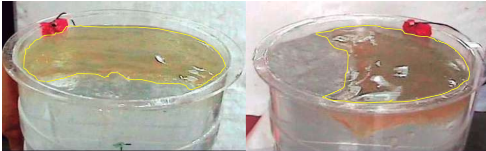
Figura 53. Fotografía de la apertura de escoria del caso 1 con un flujo de 3.0 lts. /min.
