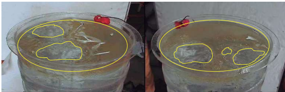
Figura 51. Fotografía de la apertura de escoria del caso 3 con un flujo de 4.9 lts./min.
