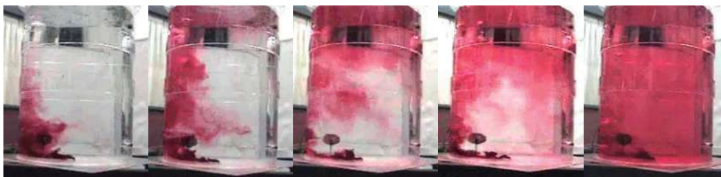
Figura 35. Fotografía tomada a los 4,6, 8, 10 y 16 segundos después de la inyección del trazador del caso 1 con un flujo de 3.0 lts / min.
