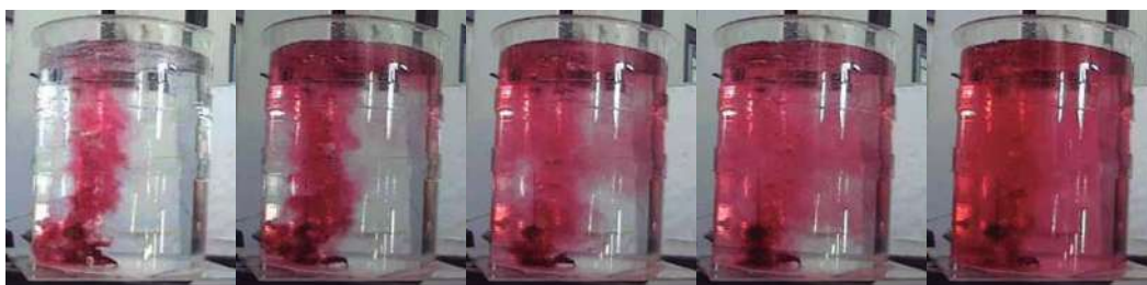
Figura 38. Fotografía tomada a los 4-6-8-10-16 segundos después de la inyección del trazador del caso 4 con un flujo de 1.50 lts / min. por cada tapón.
