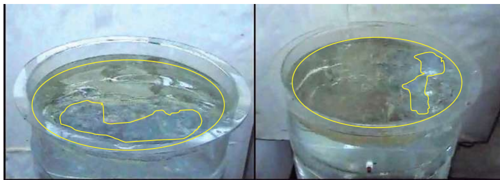
Figura 57. Fotografía de la apertura de escoria del caso 5 con un flujo de 3.0 lts. /min.
