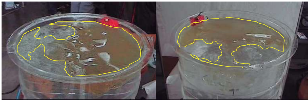
Figura 50. Fotografía de la apertura de escoria del caso 2 con un flujo de 4.9 lts./min.
