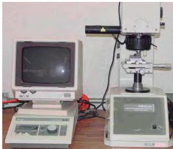
Figura 19 Microdurómetro con monitor integrado. (Mitutoyo)
