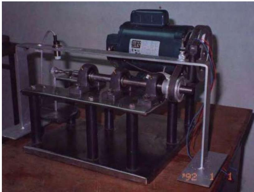
Figura 17 Prototipo para ensayos de Fatiga en Flexión Rotativa.
