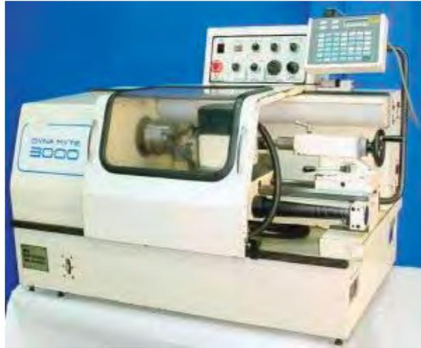
Figura 18 Torno de Control Numérico Computarizado (DYNA MYTE 3300).
