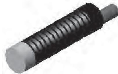
Figura 13 Vista sólida del sensor inductivo para el paro del sistema.
