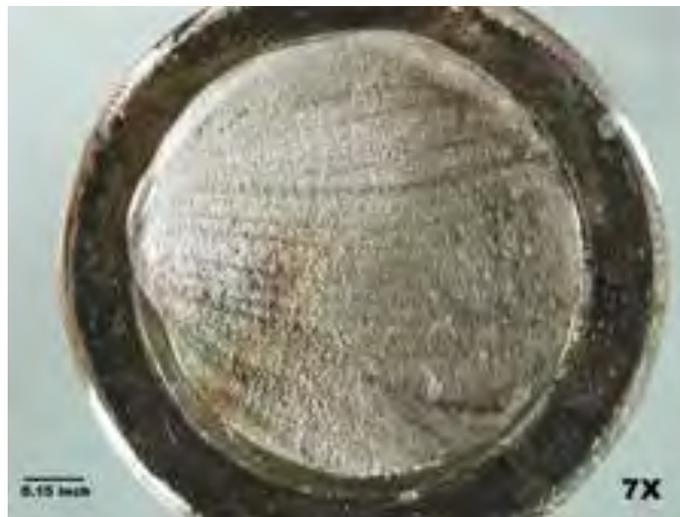
Figura 1.2 Superficie típica de fractura por fatiga.
