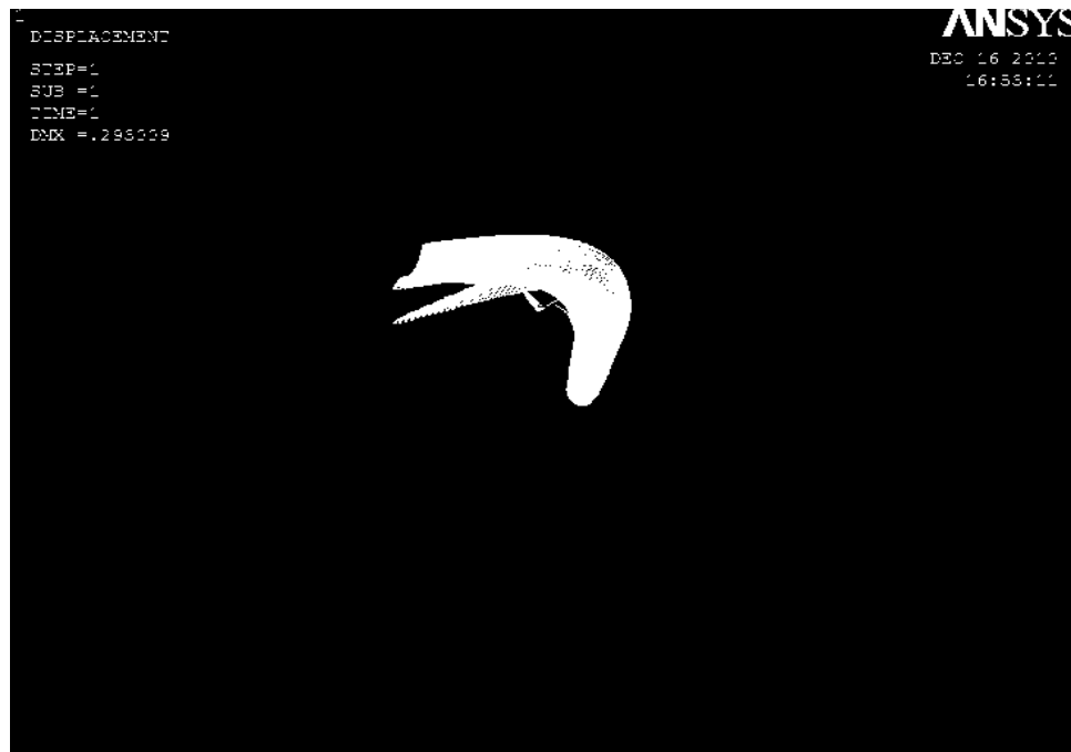
Figura 67. Posición normal del álabe y desplazamiento sufrido por la presión.
