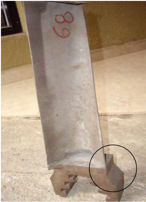
Figura 10. Álabe de estudio, mostrando zona de fractura.
