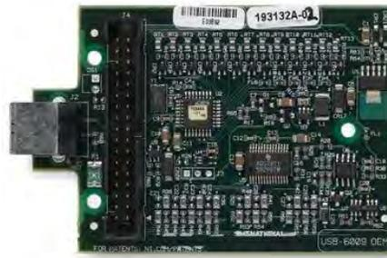
**Figura 4.1.1.2** Tarjeta de adquisición USB-6009
