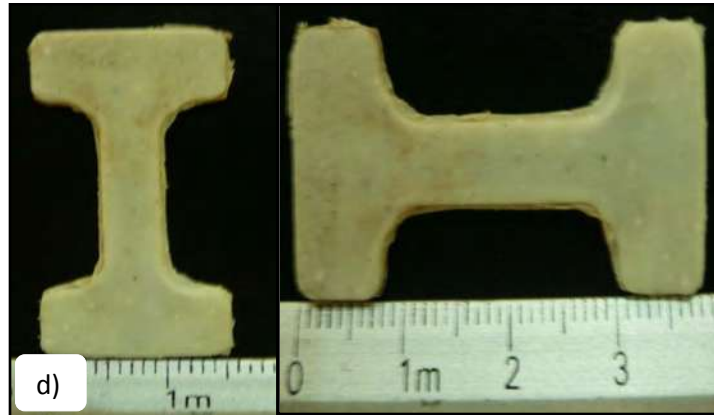
Figura 20. a) Probeta de PLA I, (90% / 10%) hidroxiapatita. b) Probeta de PLA II, (90% / 10%) hidroxiapatita. c) Probeta de PLA III, (90% / 10%) hidroxiapatita. d) Probeta de PURASORB® PL 18. Probetas de compuesto de PLA/HA, a, b, c y d con las medidas de acuerdo a la norma ASTM-D-1708 [1].
