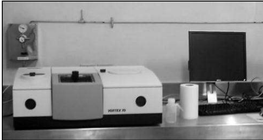
Figura 14. Espectrofotómetro de infrarrojo marca Bruker modelo Vertex 70.
