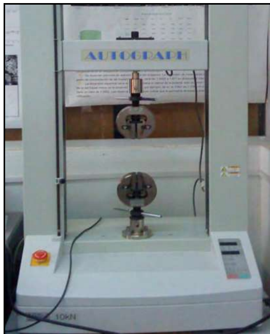
Figura 17. Máquina para evaluar la resistencia a la tensión de las probetas, marca SHIMADZU AUTOGRAPH serie AGS-J.
