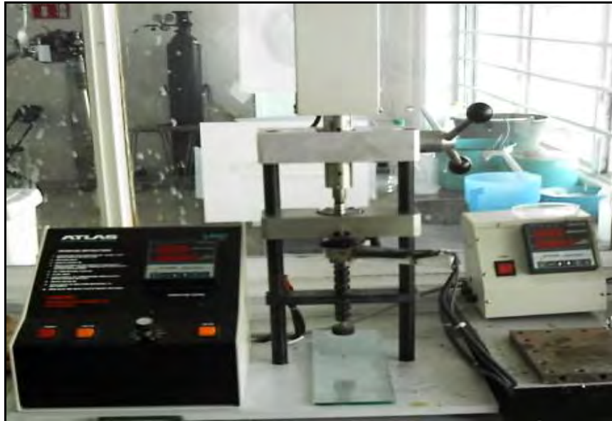
Figura 11. Inyectora marca Atlas, modelo I.MM.
