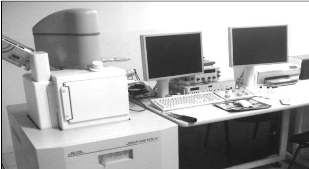
Figura 15. Microscopio electrónico de barrido JSM-6610LV.
