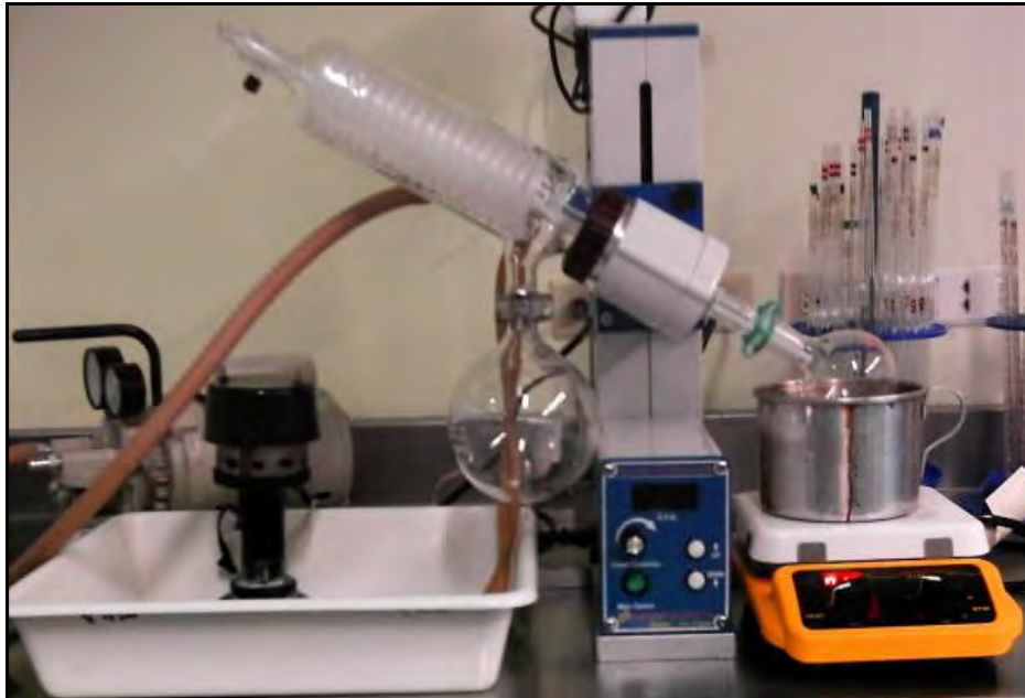
Figura 10. Esquema de trabajo general para la polimerización del ácido L (+) láctico. Matraz, rotavapor, bomba de vacío, bomba de agua, termómetro, refrigerante, cuba de agua, parrilla de calentamiento.
