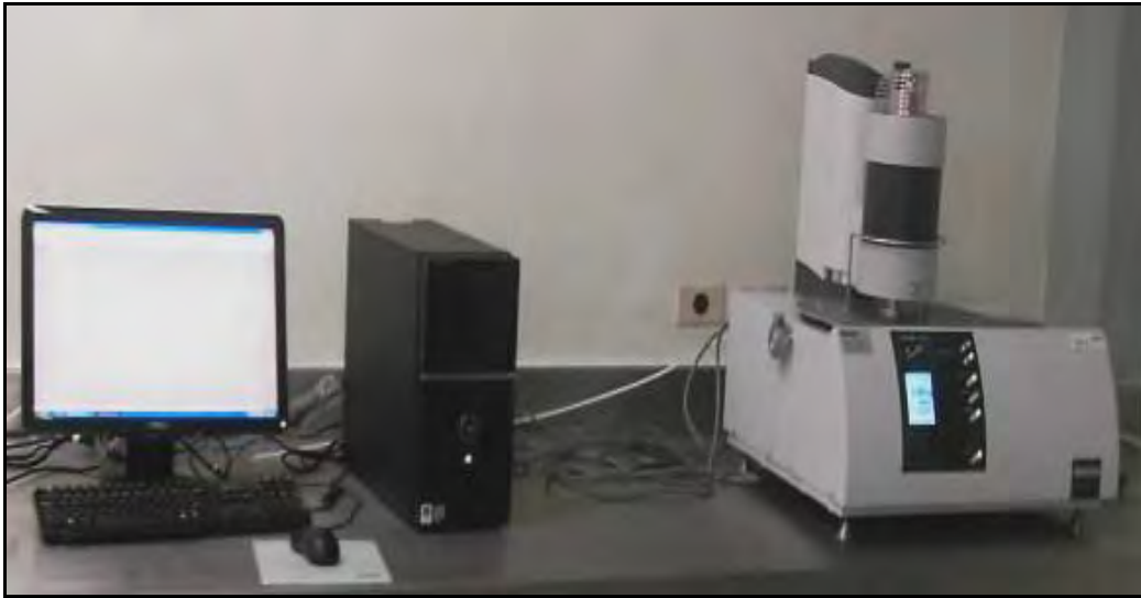
Figura 16. Instrumento marca Netzsch modelo STA 449 F3 Júpiter.
