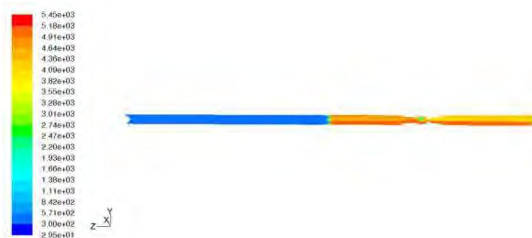
Figura 5.21. Contorno de temperatura estática (K) utilizando RNG.
