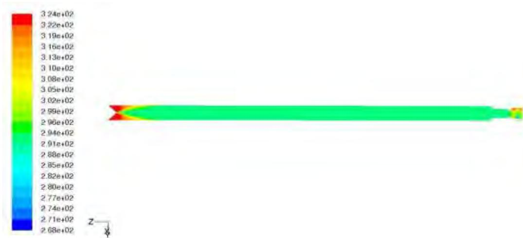
Figura 5.27 Contorno de temperatura con Pressure inlet a la entrada.
