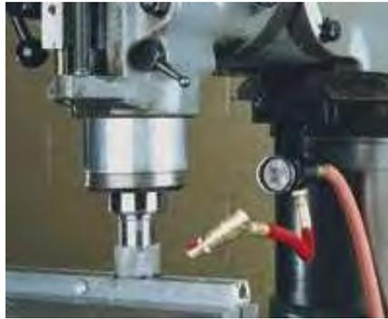
Figura 2.14. Esquema de un tubo vórtice en un taladro.
