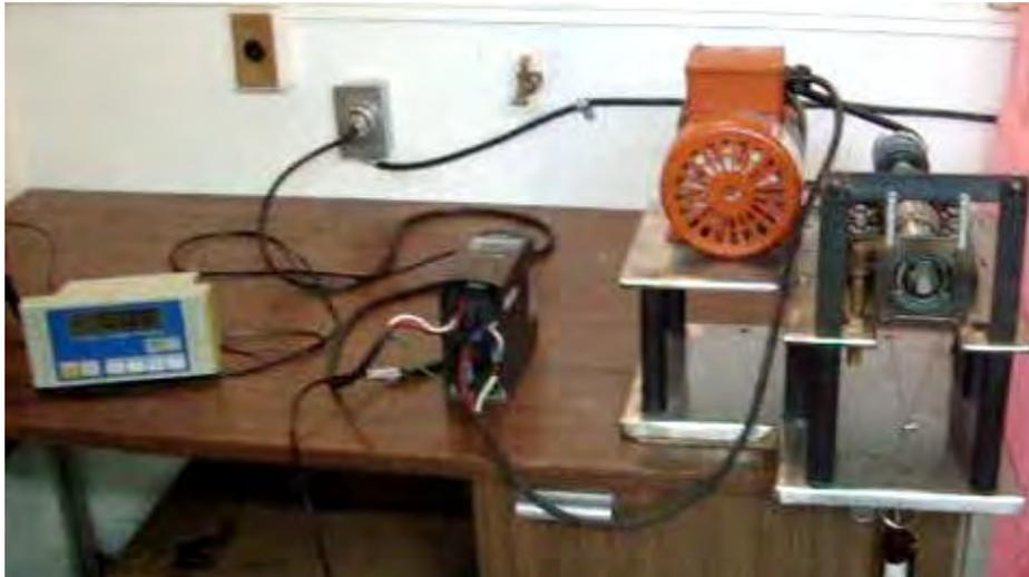
Figura 1. Dispositivo experimental para ensayos en flexión rotativa (Título de patente no. 276818, recibido en 2010)
