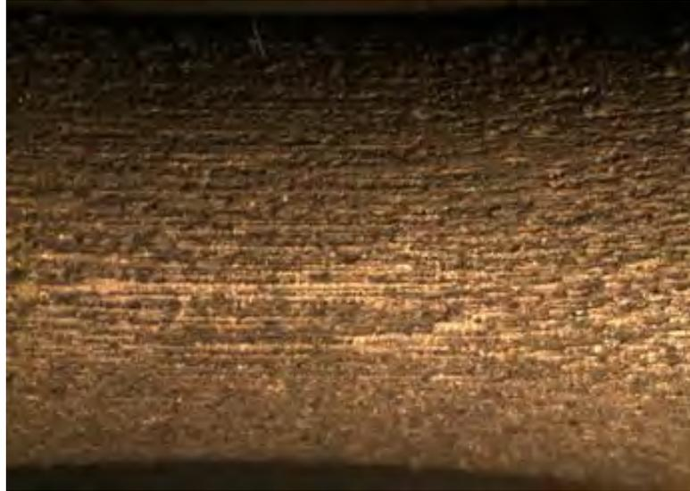
Figura 25. Superficie de probeta expuesta a 6 minutos de corrosión.
