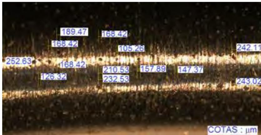
Figura 23. Superficie expuesta a 2 minutos de corrosión, aquí el brillo superficial aún se mantiene y es un tanto complicado apreciar las picaduras por corrosión.
