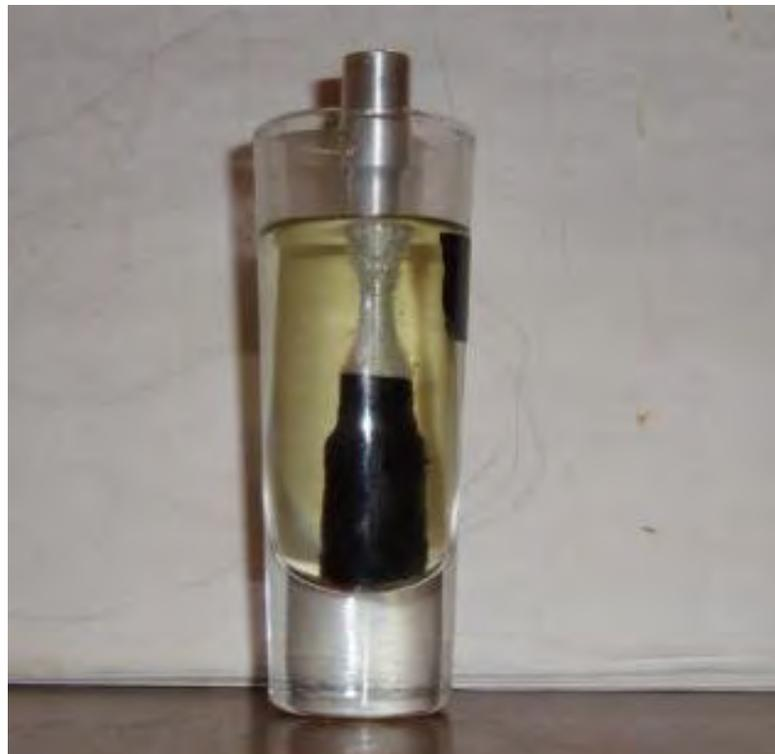
Figura 20. Probeta sumergida en ácido clorhídrico.
