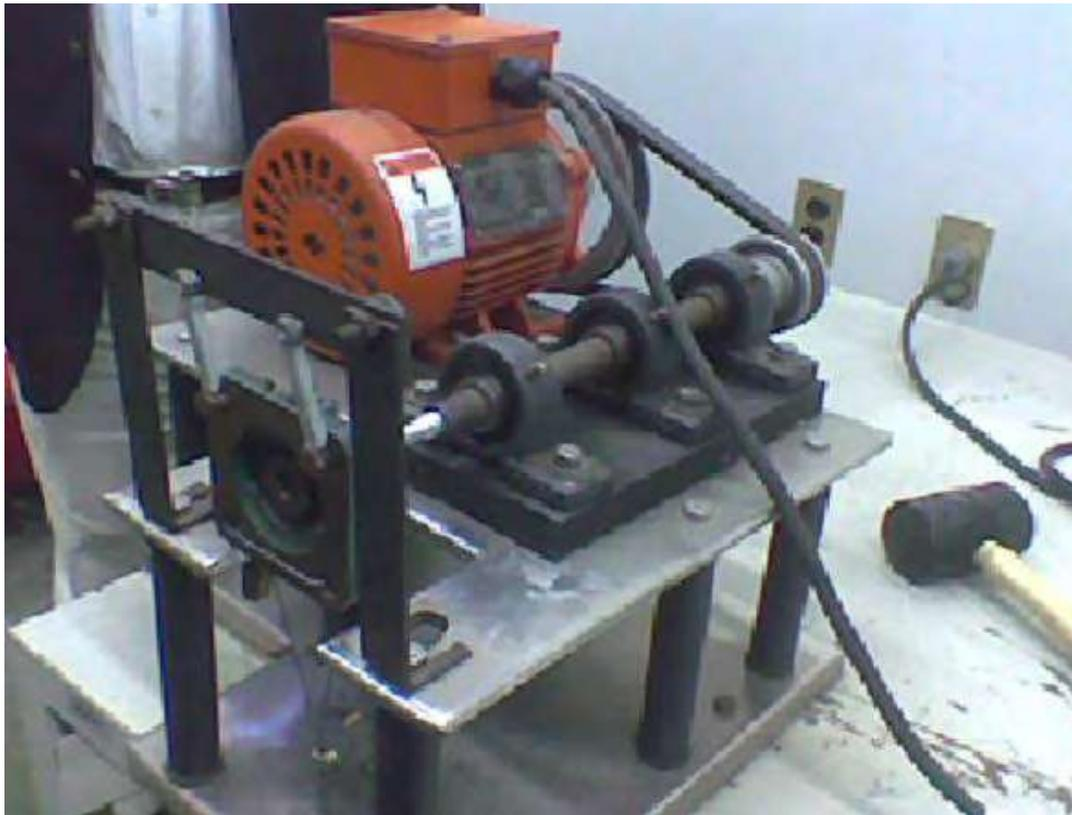
Figura 14. Máquina de fatiga por flexión rotativa antes de modificaciones.
