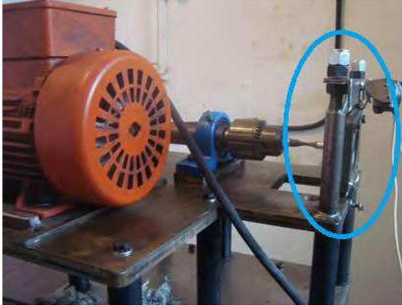
Figura 16. Sustitución de las soleras de sujeción por redondos de hierro colado.
