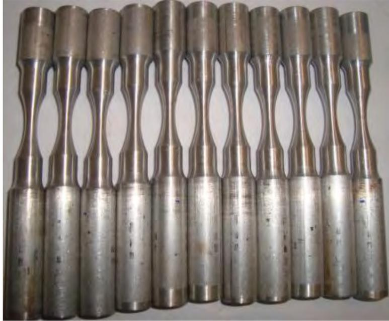
Figura 19. Tándem de probetas maquinadas en el torno de control numérico (aún sin corrosión).
