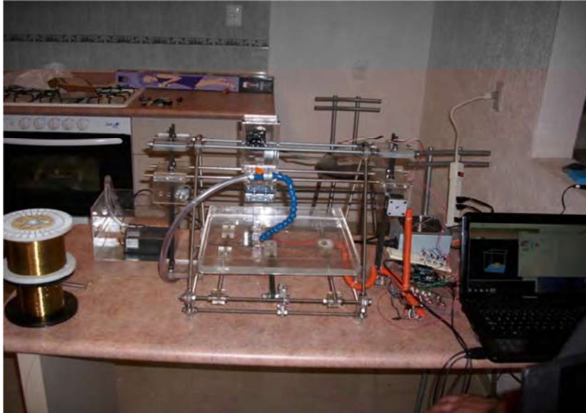
Figura 26. Máquina EDM conectada a la interfaz y control de voltaje, etc.
