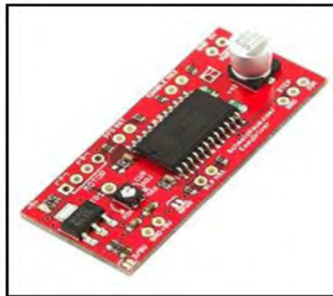
Figura 8. Tarjeta EasyDriver v4.4 para controlar los motores a pasos NEMA17. [23]
