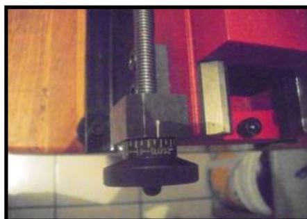
*Fig. 2.2 Manivelas de control del microtorno.*
