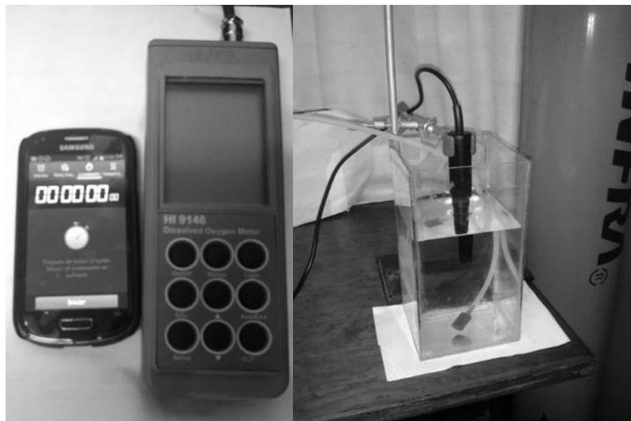
Figura 43. Sistema experimental de medición de oxígeno disuelto.
