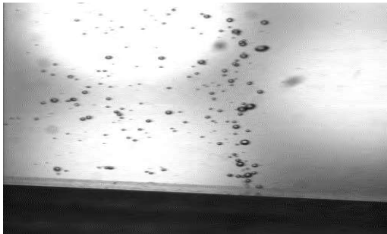
Figura 47. Aireador generando microburbujas vista frontal.
