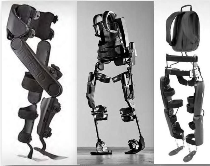
Figura 7. Algunos exoesqueletos para rehabilitación móvil: a) INDEGO® (Imagen cortesía de Parker Hannifin™ b) Ekso™ (Imagen cortesía de Ekso Bionics™) y c) ReWalk™ (Imagen cortesía de ReWalk Robotics™).
