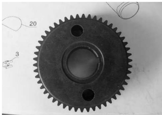
Figura 31. Pieza 53 del equipo DW130. Engrane recto de acero endurecido, 50 dientes, módulo 1 y ángulo de presión 14.5.
