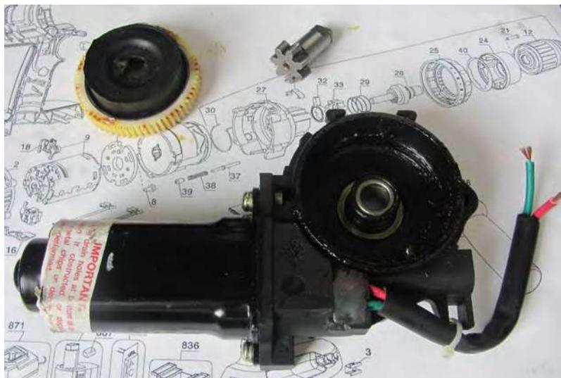
Figura 24. Especimen 1, Motor de corriente directa con transmisión de engranaje sinfin-corona.
