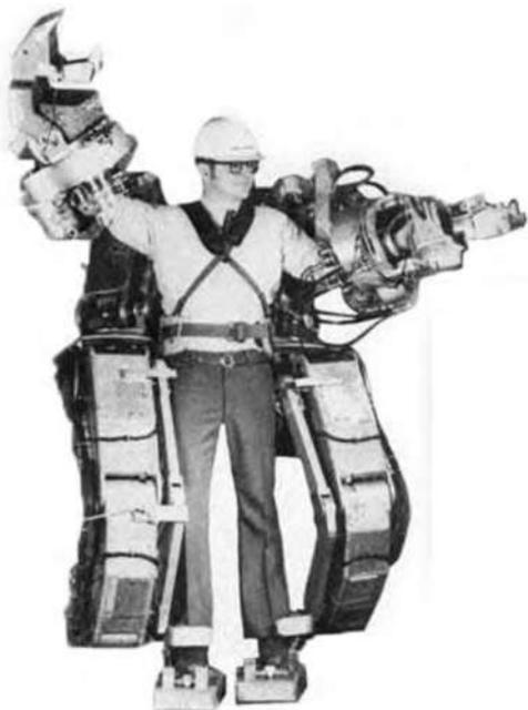
Figura 6. Exoesqueleto Hardiman, cortesía G.E.
