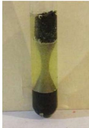
Fig.3.12. Probeta inmersa en ácido para el proceso de pre-corrosión
