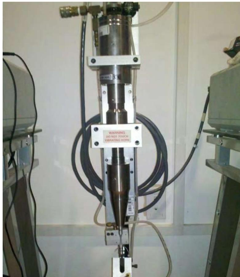
**Fig. I. I.** Piezoeléctrico y multiplicador de desplazamiento.
