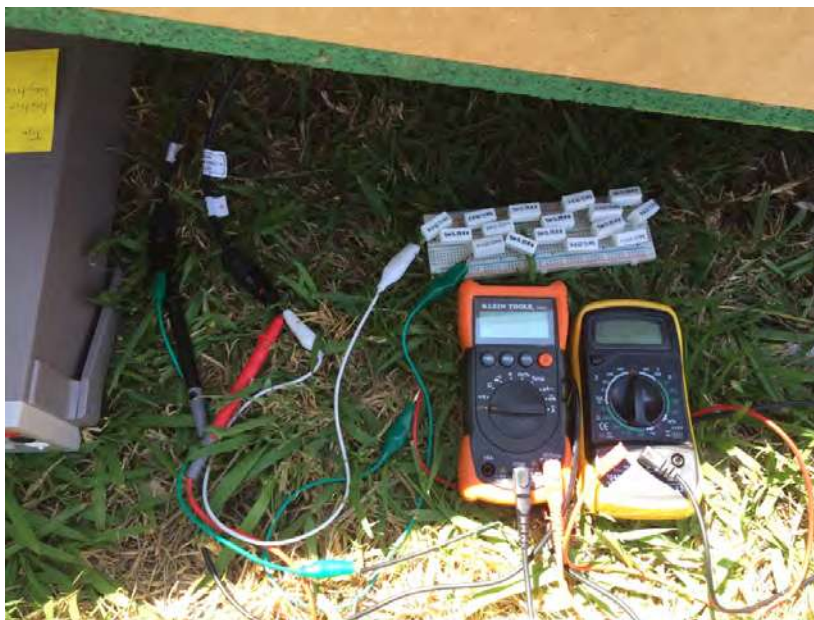
Figura 5.7. Instrumentos conectados al colector para medición de electricidad.
