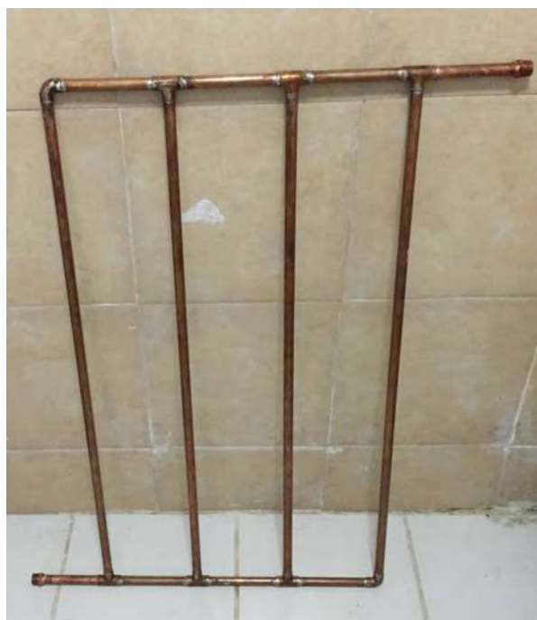
Figura 5.2. Arreglo de tubos terminado.
