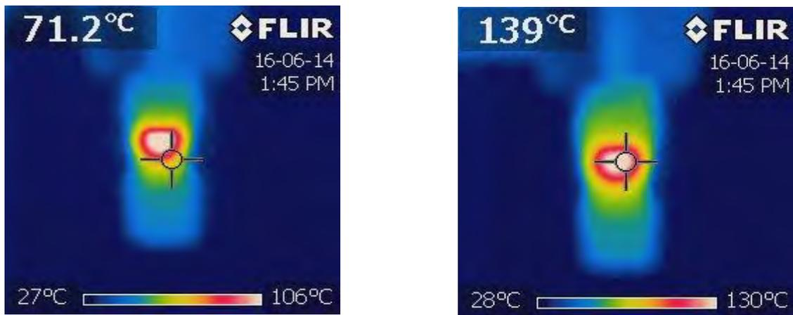
*Figura 37. Probetas sometidas a fatiga ultrasónica.*
