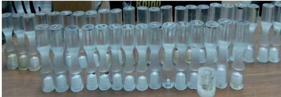
*Figura 41. Probetas para ensayos en fatiga ultrasónica.*
