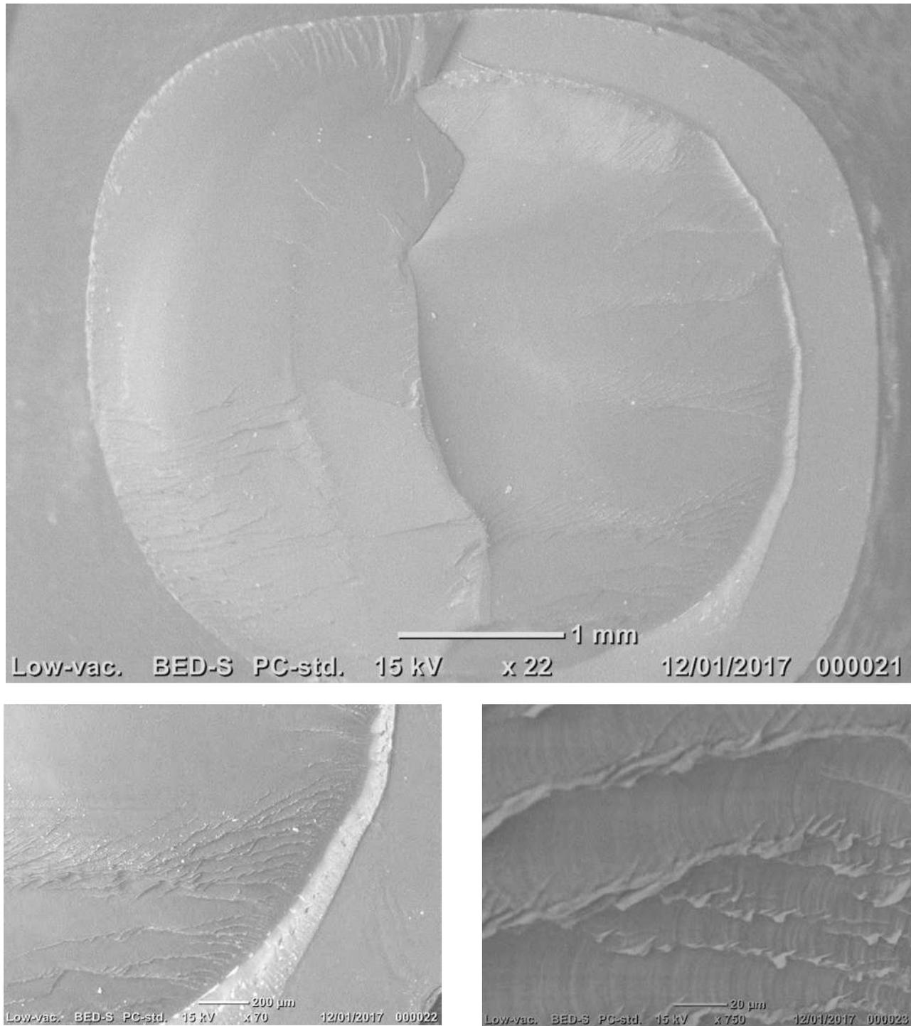
*Figura 44. Imágenes de superficie de fisura, muestra ensayada a 9.61% del límite elástico del material.*
