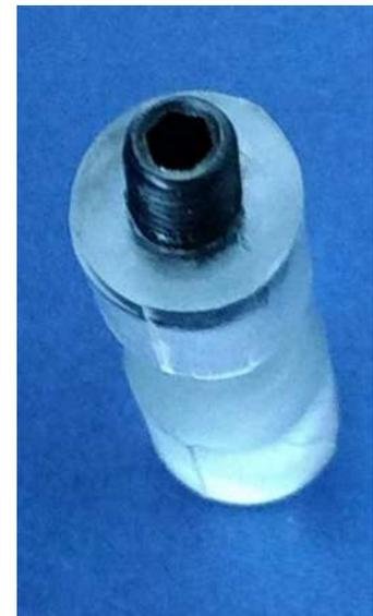
*Figura 35. Probetas con pernos para ensayos de fatiga ultrasónica.*
