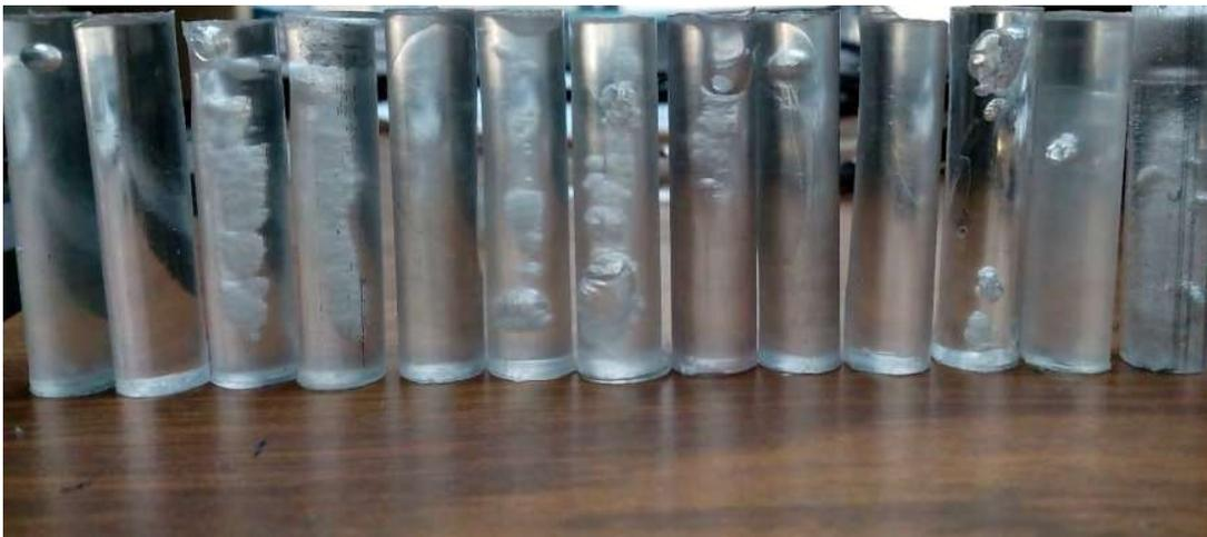
*Figura 27. Proceso de mala fabricación del material PMMA.*
