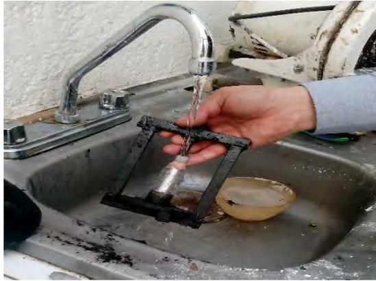
*Figura 22. Enfriamiento y extracción final del material.*
