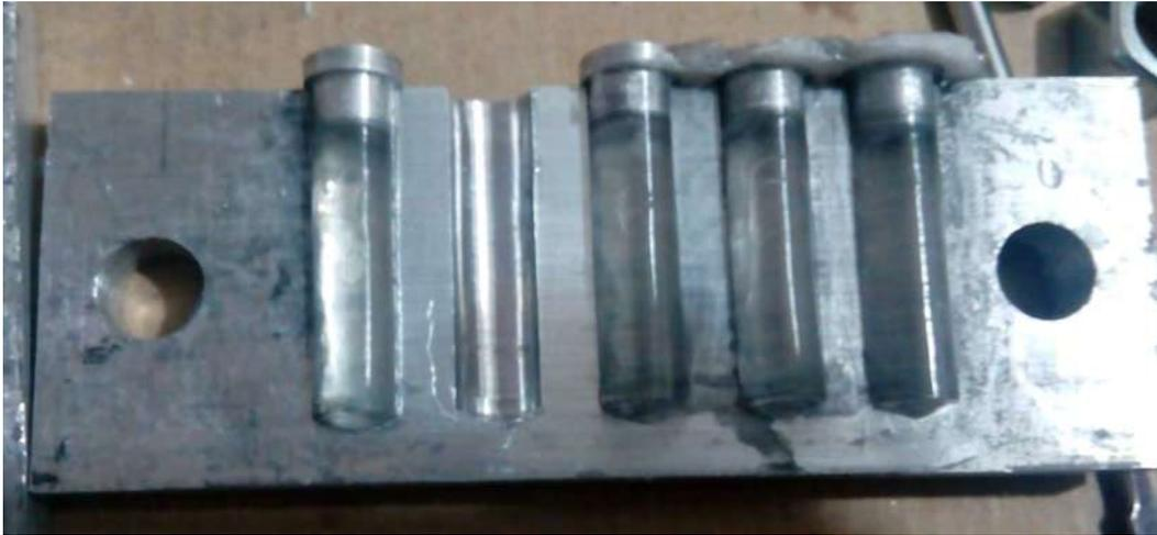
*Figura 26. Obtención de las probetas.*
