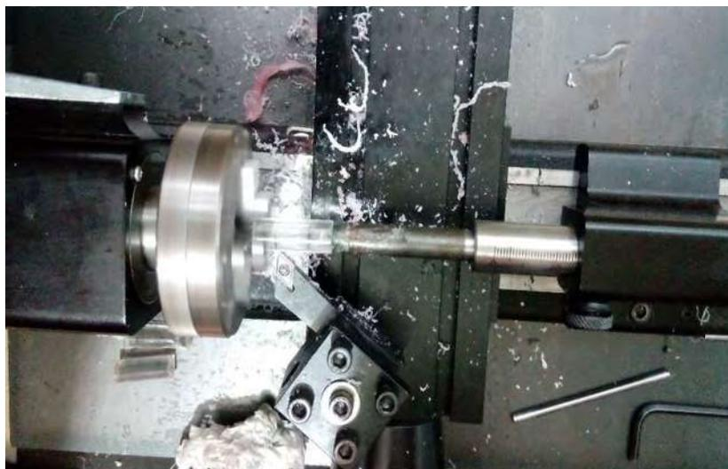
*Figura 32. Referencia inicial y maquinado de cintura.*
