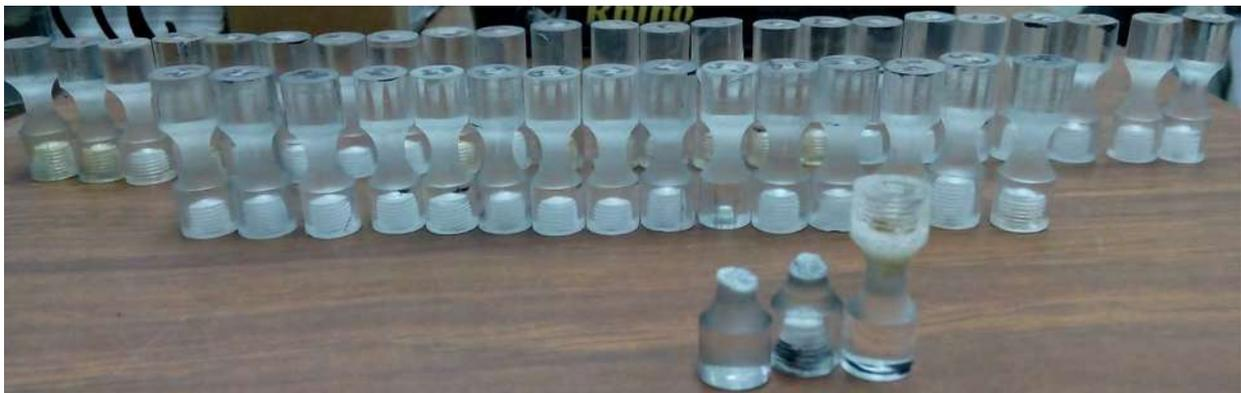
*Figura 28. Maquinado final de probetas de PMMA.*
