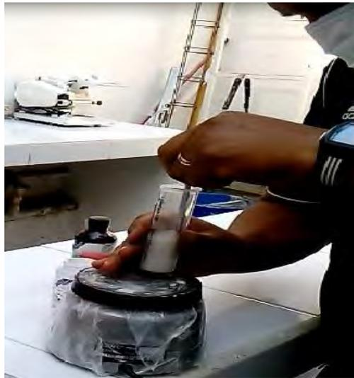
*Figura 19. Mezcla final de líquido polvo de PMMA.*
