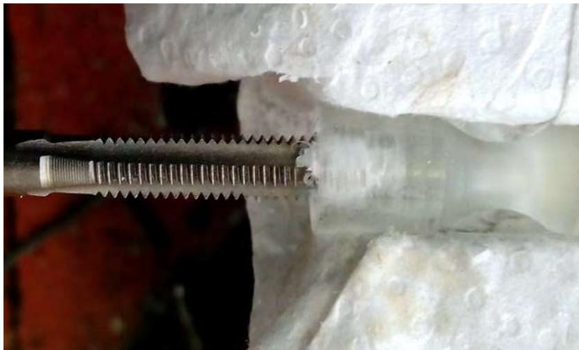
*Figura 34. Fabricación de rosca interna en probeta.*
