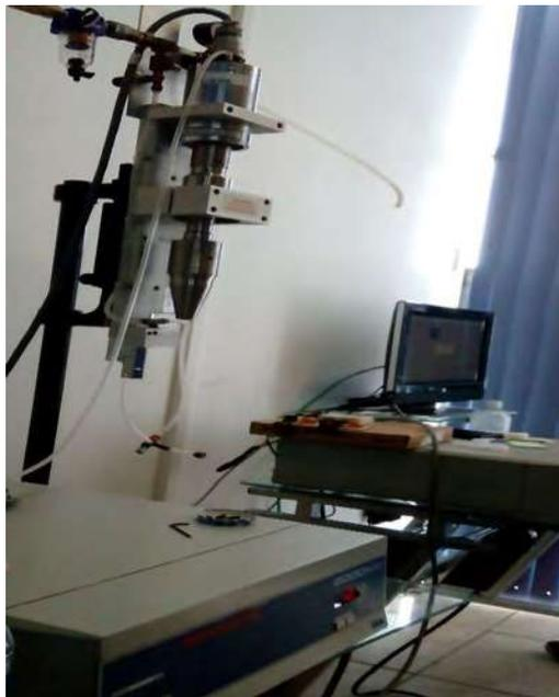
*Figura 36. Conjunto generador, Piezoeléctrico y multiplicador.*
