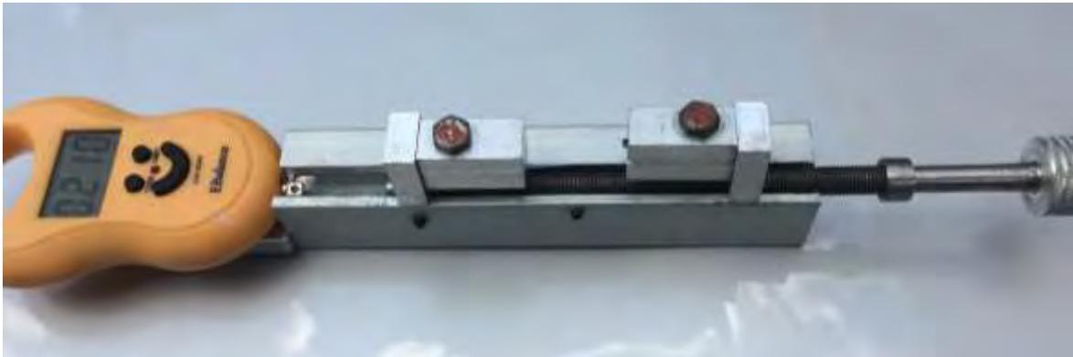
**Figura 3. 4.** Mecanismo de tensión con celda de carga digital.
