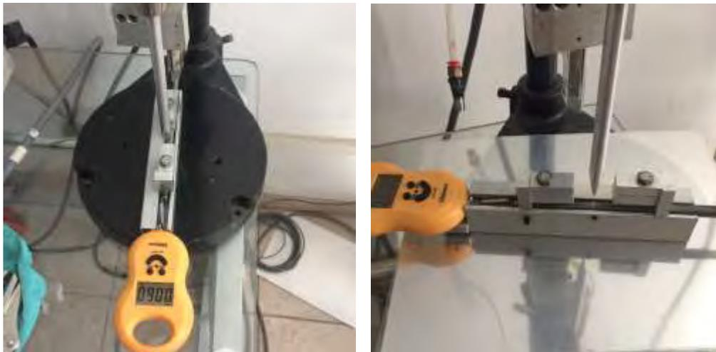
**Figura 4. 1.** Calibraciones de tensión inicial en la máquina de fatiga ultrasónica.
