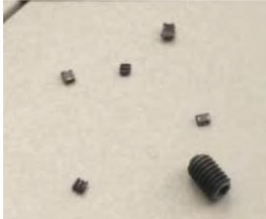
**Figura 3. 9.** Opresor de conexión entre el punzón y el sonotrodo fracturado.
