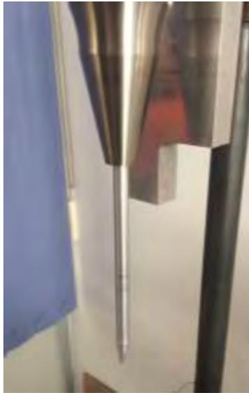
**Figura 3. 8.** Punzón en pruebas de resonancia.
