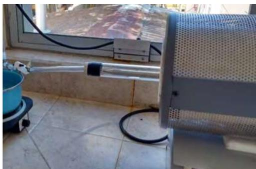
**Figura 19. Reactor CVD con barra de acero como catalizador.**
