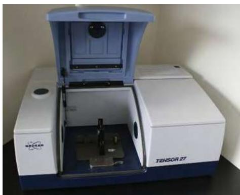
**Figura 22. Espectrómetro Infrarrojo**
