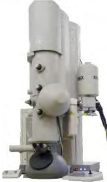
**Figura 25. Microscopio electrónico de transmisión .**
