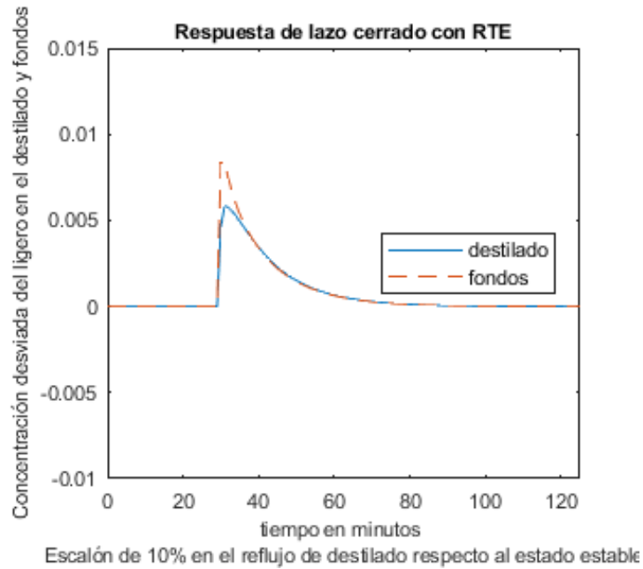
Figura 5.29: LCRTE. Respuesta de ligeros en el destilado y fondos como variable desviada ante un cambio del 10% en el reflujo de destilado
