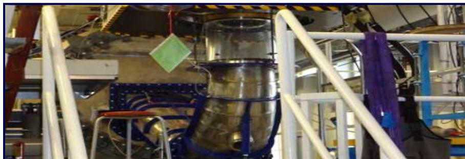
Figura 3.1. Vista completa de la carcasa espiral, el cono y el tubo de aspiración conectado al tanque de aguas abajo; obtenido de <https://www.ntnu.edu/nvks/francis-99>.
