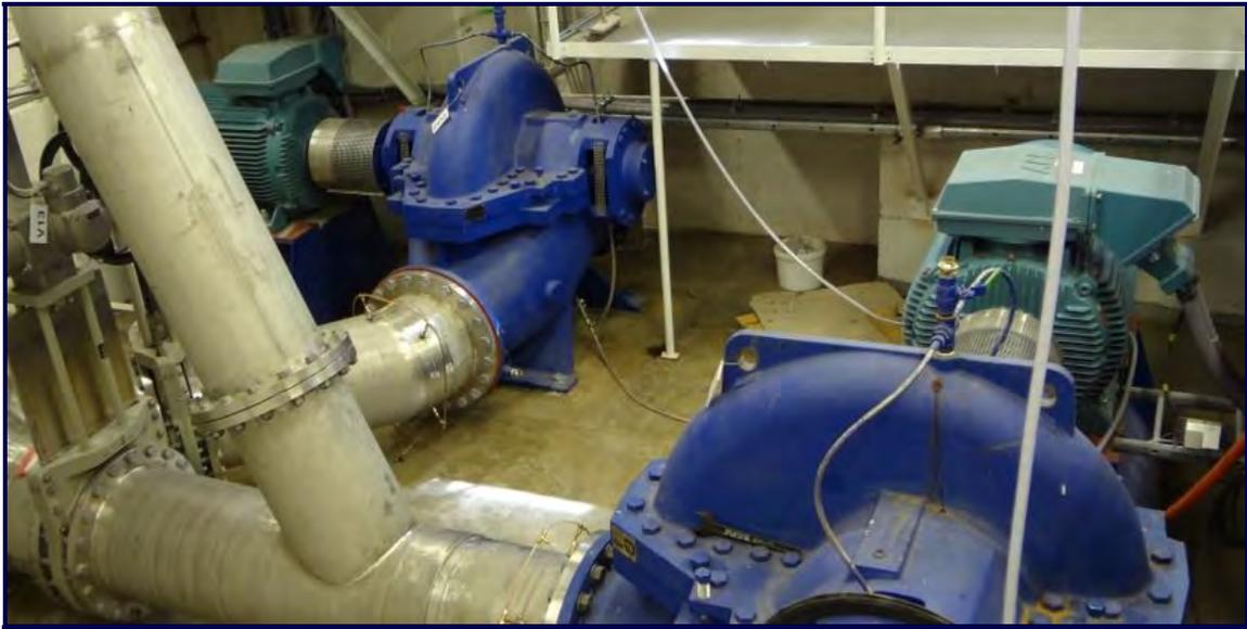
Figura 3.4. Sistema de bombeo para la plataforma de prueba de la turbina Tokke; obtenido de <https://www.ntnu.edu/nvks/francis-99>.
