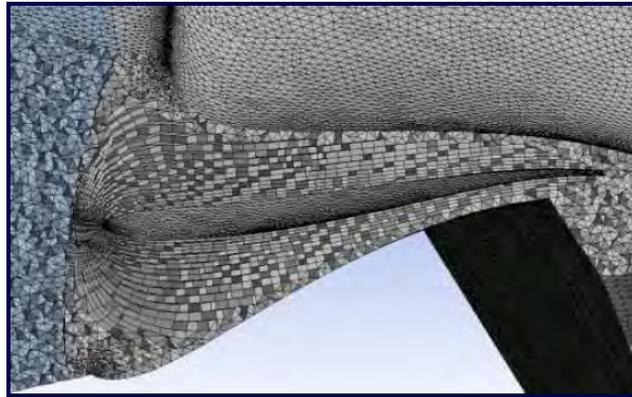
Figura 1.43. Detalles de la malla del rodete GAMM para el estudio rotatorio; obtenido de Roig (2017)
