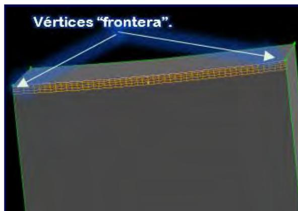
Figura 4.62. Vértices empleados para el comando de cierre de capa límite.
