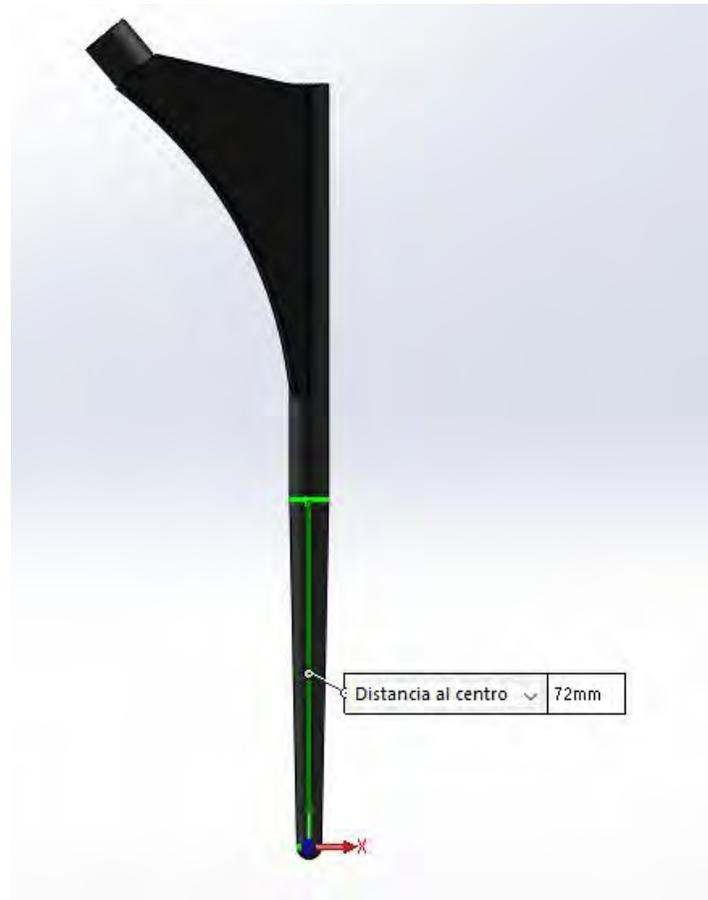
*Figura 3.8. Modelo prótesis 1 (vástago 72 mm).*
