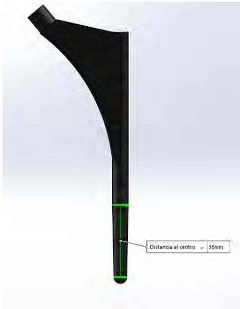
*Figura 3.9. Modelo prótesis 2 (vástago 36 mm).*
