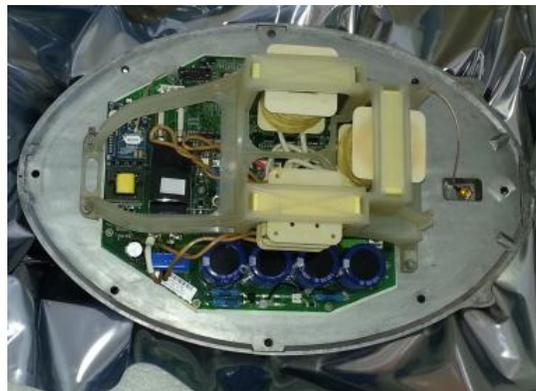
Figura 3.19: Tarjeta electrónica que contiene el rectificador trifásico.
