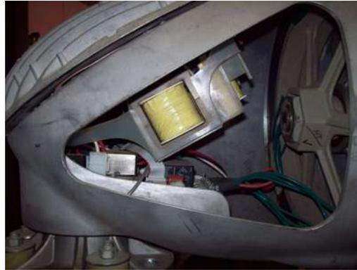
Figura 3.18: Vista interior del generador.
