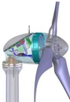
Figura 3.32: Ubicación de antena para sistema de monitoreo.
