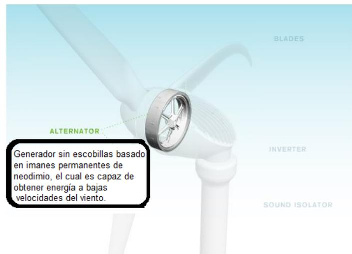
Figura 3.17: Generador de imanes permanentes.
