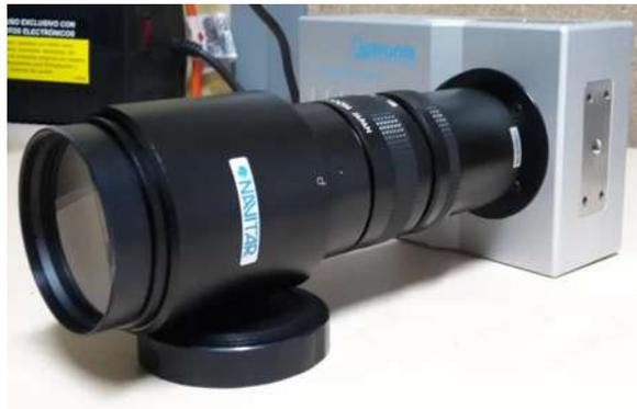
Figura 3.6 Cámara rápida utilizada para la captura de imágenes con una lente acoplada para la observación del fenómeno.
