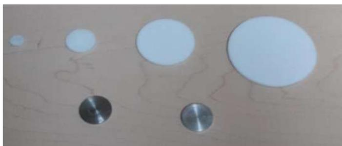
Figura 3.3 Discos sólidos de diferentes diámetros, parte superior discos de teflón y parte inferior disco de acero y disco de aluminio.
