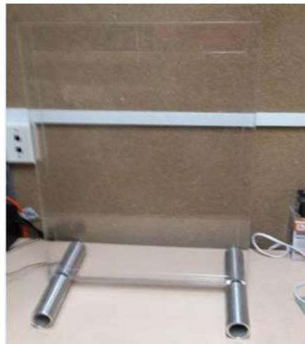
Figura 3.2. Celda bidimensional con su base de cilindros.
