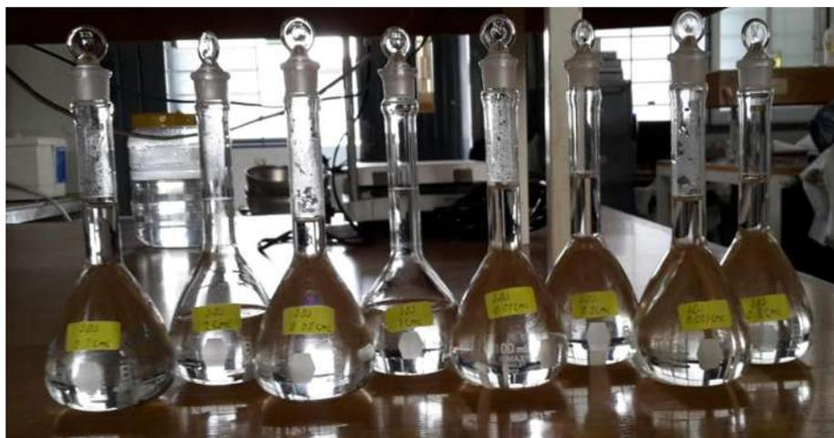
Figura 3.11 Muestras de las soluciones acuosas para medir su tensión superficial.
