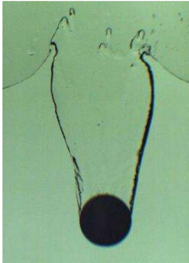
Figura 4.2 Cavidad de aire en 2D por impacto de un disco de teflón de diámetro de 1”.
