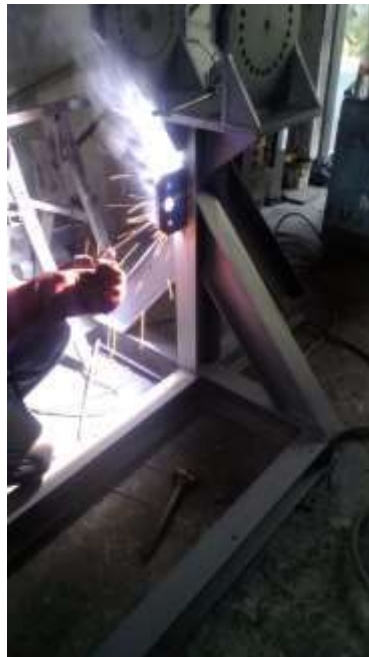
Figura 63. Soldadura de placa al banco de pruebas.
