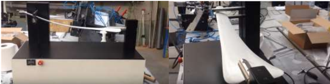
Figura 4. Máquina de ensayo estático y de fatiga desarrollada por la empresa CEAD.[Fuente:www.ceadgroup.com]
