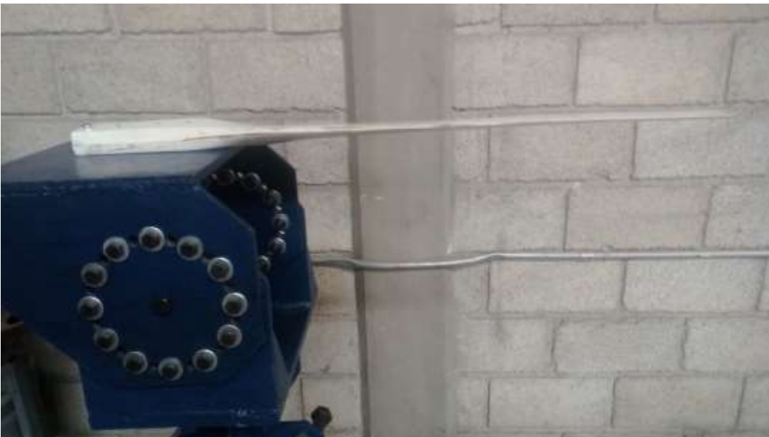
Figura 68. Colocación del álabe en la máquina de ensayos.
