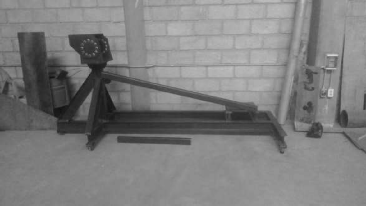
Figura 67. Colocación de barra de en la máquina de ensayos.
