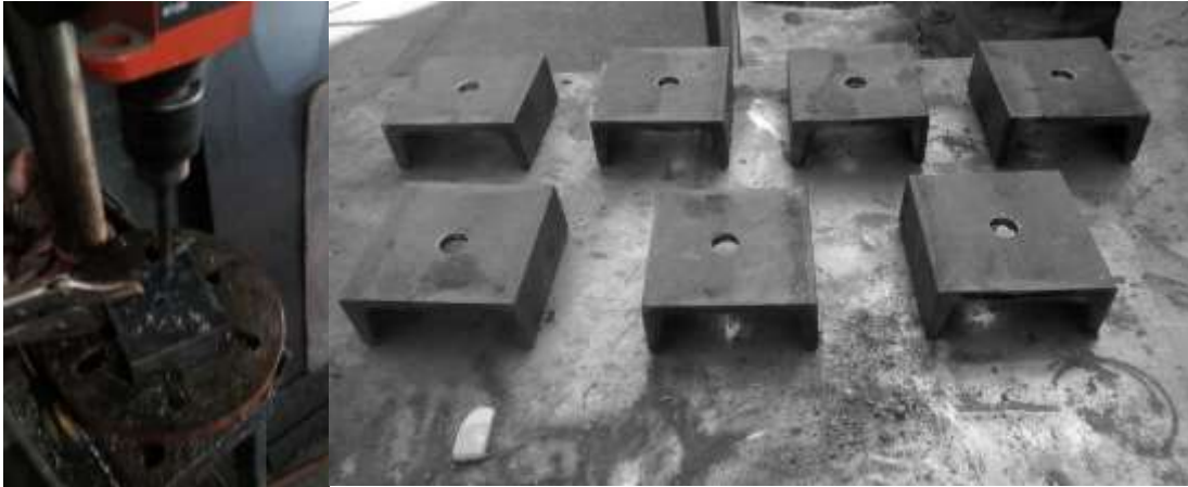
Figura 55. Fabricación de las bases para niveladores.
