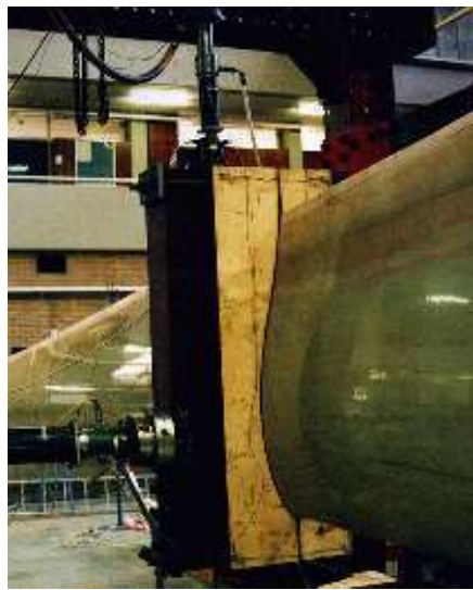
Figura 12. Accesorio de fijación del álabe usando un manguito externo de madera [2].
