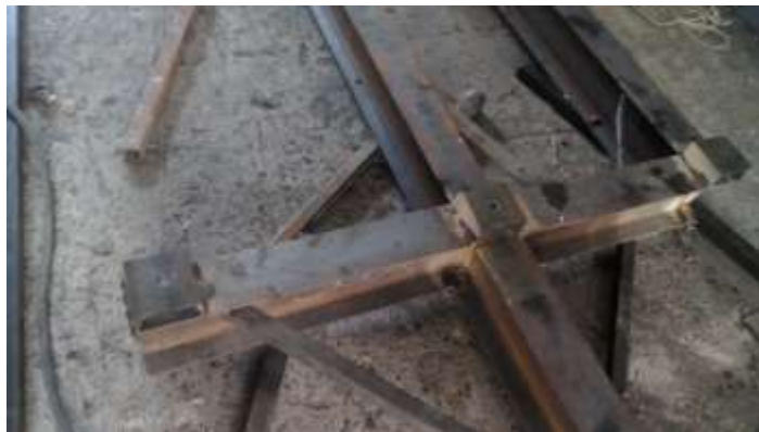
Figura 61. Soldadora de niveladores a la base.
