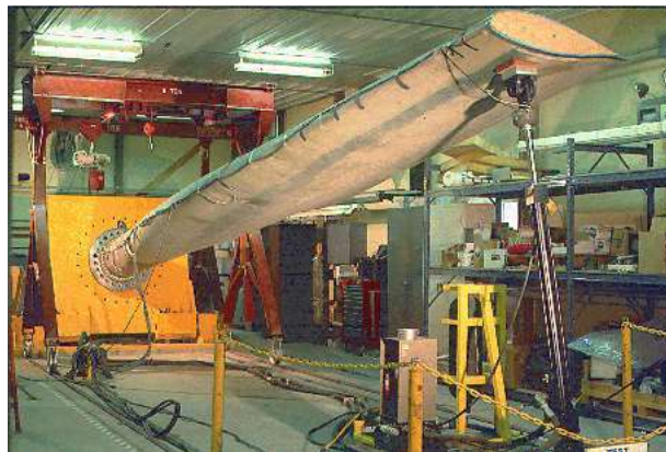
Figura 13. Ejemplo de configuración de prueba uniaxial utilizando un actuador hidráulico (NREL, EE. UU.) [2].
