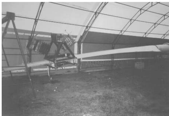
Figura 15. Ejemplo de configuración de prueba utilizando una masa giratoria excéntrica (Riso, Dinamarca) [2].
